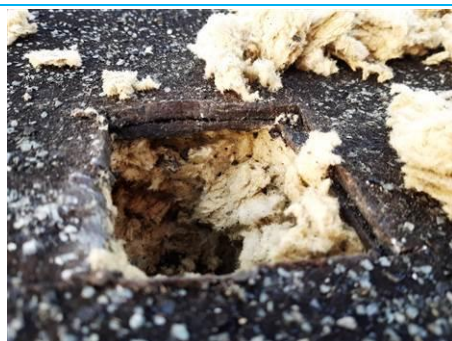
Matériaux : ZPSO-029 Prélèvement : P029 Description : Partie plane : Isolant Localisation : Toiture Résultat : Absence d'amiante Quantité :
