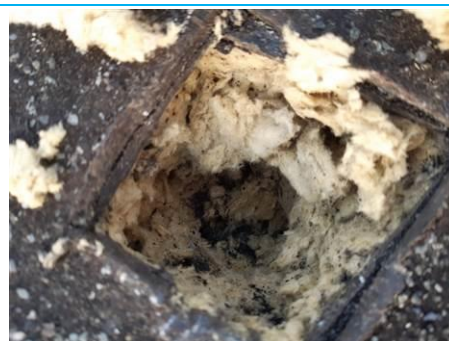
Matériaux : ZPSO-030 Prélèvement : P030 Description : Partie plane : pare vapeur Localisation : Toiture Résultat : Absence d'amiante Quantité :
