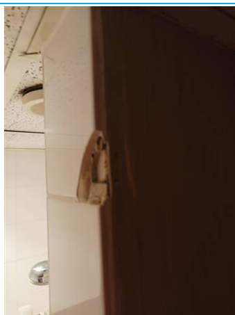
Matériaux : ZPSO-021 Prélèvement : P021 Description : Colle de faïence Localisation : Rez de chaussée - Chambre 017 Résultat : Absence d'amiante Quantité :
