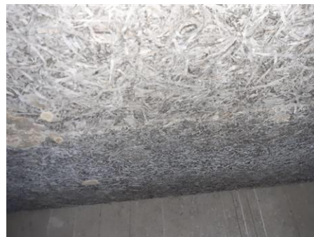
Matériaux : ZPSO-010 Prélèvement : P010 Description : Enduit de jointoiment et plot de colle des plaques de plâtre Localisation : Vide sanitaire Résultat : Absence d'amiante Quantité :
