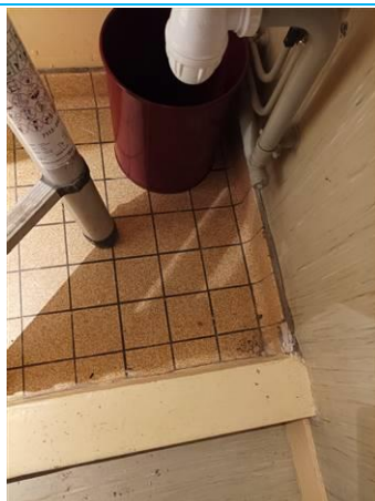
Matériaux : ZPSO-023 Prélèvement : P023 Description : Colle de plinthe Localisation : Rez de chaussée - Chambre 017 Résultat : Absence d'amiante Quantité :
