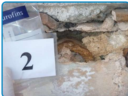
PRLV n° 2 sur Génoise Mortier de scellement
