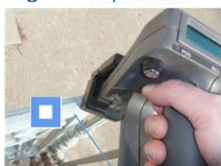
Peinture plombée sur garde-corps balcon
