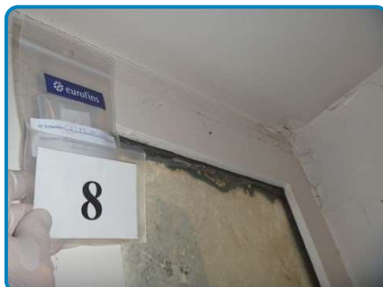
PRLV n° 8 sur Menuiserie Mastic de vitrage coulant
