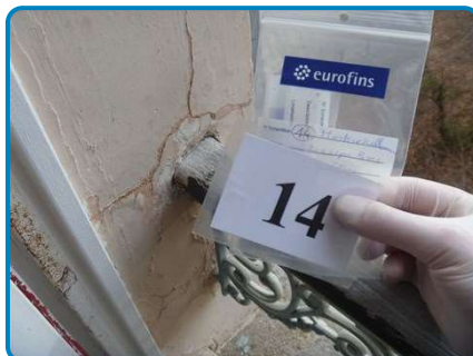
PRLV n° 14 sur Garde-Corps bois (fenêtre étage) Mortier de scellement
