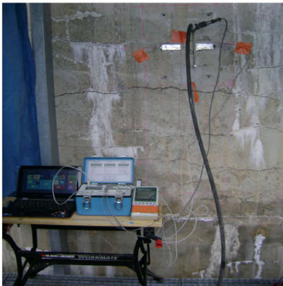
Instrumentation « libération de contrainte »
