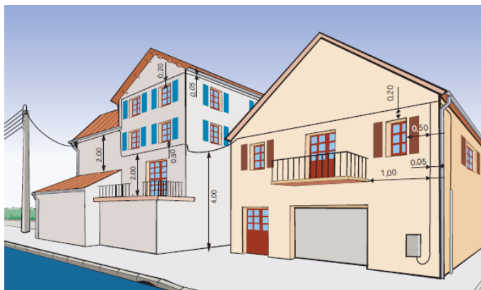
Branchements BT – Cas d'un cheminement en façade. Préconisations du Guide d'application de l'arrêté ministériel du 2 avril 1991, fixant les conditions techniques de la distribution d'électricité.
