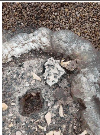
Prélèvement - P036 : Cour d'appel / Toiture local ménage - Complexe d'étanchéité asphalté- (Absence d'amiante)
