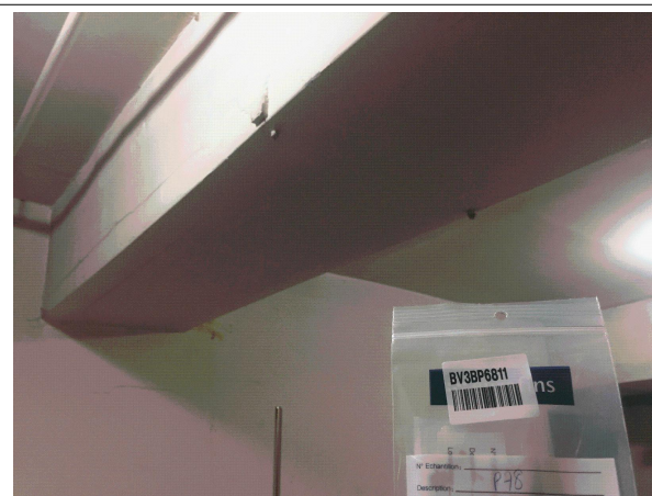
Prélèvement - P078 : BATIMENT 1 / SOUS SOL 2 / Local -208 - Enduit- (Absence d'amiante)
