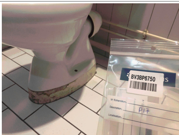
Prélèvement - P017 : BATIMENT 1 / RDC / Local 24 - Enduit- (Présence d'amiante)
