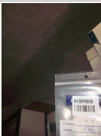
Prélèvement - P076 : BATIMENT 1 / SOUS SOL 2 / Local -207 - Enduit de lissage- (Présence d'amiante)
