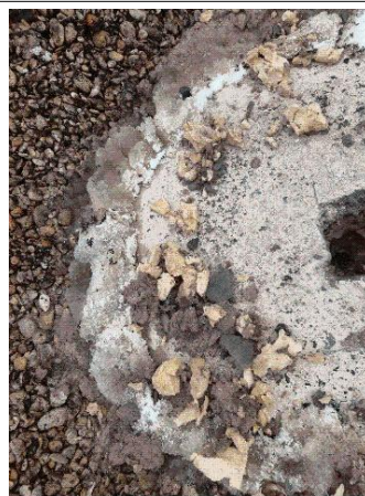
Prélèvement - P034 : Cour d'appel / Toiture local ménage - Isolant- (Absence d'amiante)
