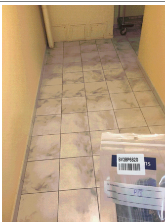
Prélèvement - P088 : BATIMENT 1 / SOUS SOL 1 / Local -121 - Colle de carrelage- (Absence d'amiante)
