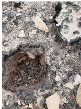
Prélèvement - P038 : Cour d'appel / Toiture local ménage - Pare-vapeur- (Absence d'amiante)
