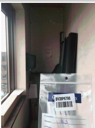
Prélèvement - P063 : BATIMENT 1 / ETAGE2 / Circulation - Enduit- (Absence d'amiante)
