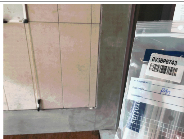
Prélèvement - P010 : BATIMENT 1 / RDC / Local 20 - Enduit- (Présence d'amiante)
