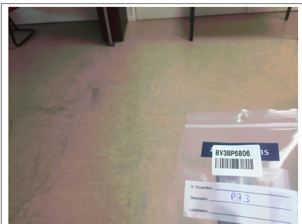
Prélèvement - P073 : BATIMENT 1 / RDC / Local 27 - Colle- (Absence d'amiante)
