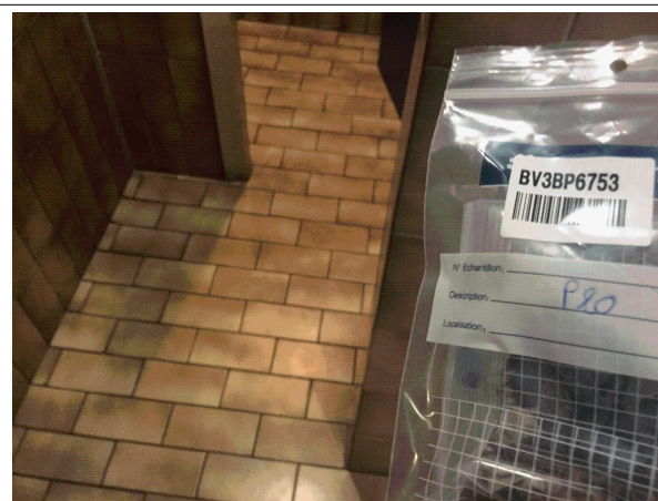
Prélèvement - P020 : BATIMENT 1 / RDC / Local 22 - Colle de carrelage- (Absence d'amiante)
