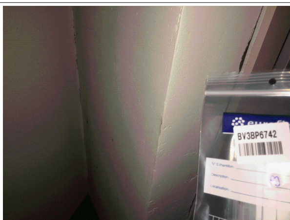
Prélèvement - P009 : BATIMENT 1 / RDC / Local 16 - Enduit- (Absence d'amiante)
