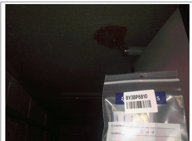
Prélèvement - P077 : BATIMENT 1 / SOUS SOL 2 / Local -205 - Flocage- (Absence d'amiante)
