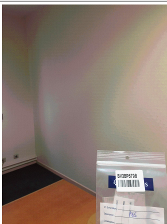
Prélèvement - P065 : BATIMENT 1 / ETAGE2 / Local 218 - Enduit- (Absence d'amiante)
