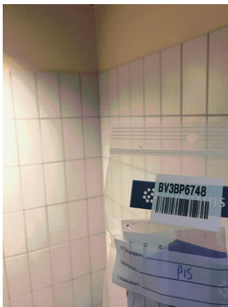
Prélèvement - P015 : BATIMENT 1 / RDC / Local 24 - Colle de faïence- (Absence d'amiante)
