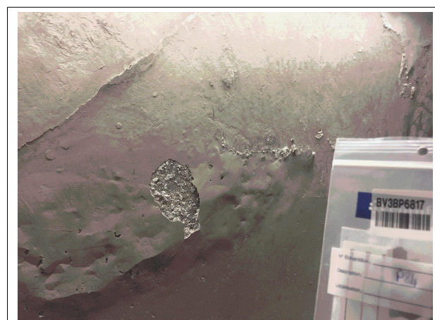
Prélèvement - P084 : BATIMENT 1 / SOUS SOL 2 / Local -201 - Enduit- (Présence d'amiante)
