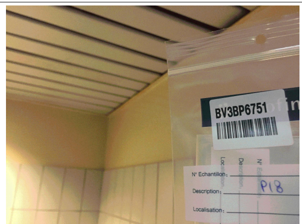
Prélèvement - P018 : BATIMENT 1 / RDC / Local 24 - Enduit- (Présence d'amiante)
