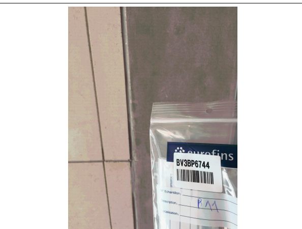
Prélèvement - P011 : BATIMENT 1 / RDC / Local 20 - Joint- (Absence d'amiante)
