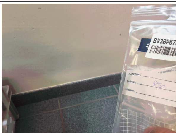
Prélèvement - P051 : BATIMENT 1 / ETAGE1 / Local 111 - Colle de plinthe- (Absence d'amiante)
