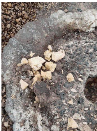
Prélèvement - P037 : Cour d'appel / Toiture local ménage - Isolant- (Absence d'amiante)
