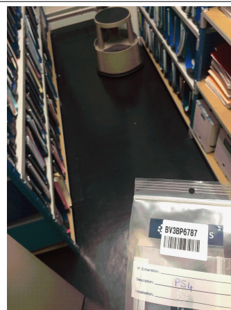
Prélèvement - P054 : BATIMENT 1 / ETAGE1 / Archives - Colle - (Absence d'amiante)
