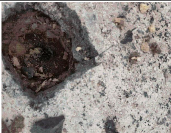
Prélèvement - P035 : Cour d'appel / Toiture local ménage - Pare-vapeur- (Absence d'amiante)
