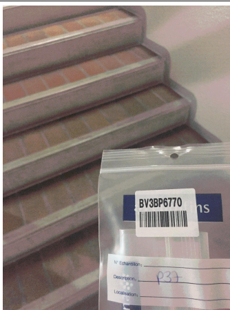
Prélèvement - P037 : BATIMENT 1 / RDC / Escalier 1 - Nez de marche- (Absence d'amiante)
