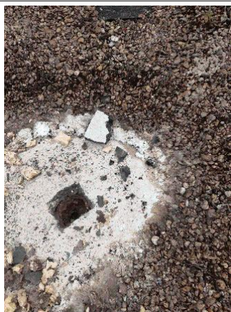
Prélèvement - P033 : Cour d'appel / Toiture local ménage - Complexe d'étanchéité asphalté- (Absence d'amiante)
