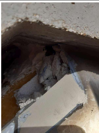
Prélèvement - P047 : Cour d'appel / Façades Est - Joint- (Présence d'amiante)
