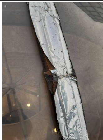
Prélèvement - P020 : Cour d'appel / Toiture salle d'audience / Dôme - Mastic- (Absence d'amiante)
