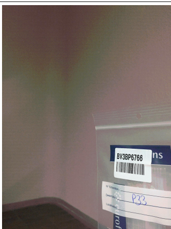
Prélèvement - P033 : BATIMENT 1 / RDC / Escalier 1 - Enduit projeté- (Absence d'amiante)
