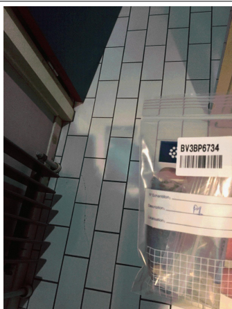
Prélèvement - P001 : BATIMENT 1 / RDC / Local 3 - Colle de carrelage- (Présence d'amiante)
