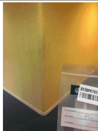
Prélèvement - P050 : BATIMENT 1 / ETAGE1 / Circulation - Enduit- (Présence d'amiante)
