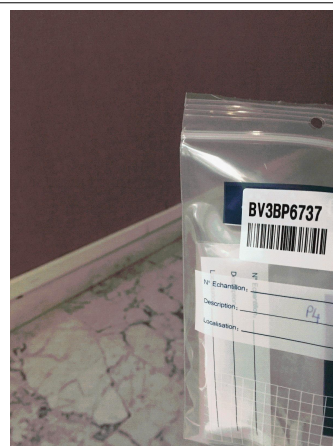
Prélèvement - P004 : BATIMENT 1 / RDC / Local 2 - Colle de plinthe- (Absence d'amiante)
