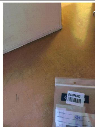
Prélèvement - P091 : BATIMENT 1 / SOUS SOL 1 / Local -103 - Dalle de sol- (Présence d'amiante)
