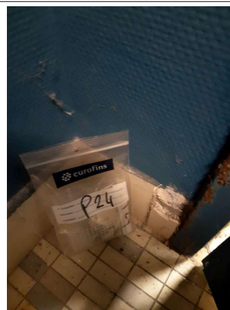
Prélèvement - P024 : RDC / 221.00.45 - Colle- (Absence d'amiante)
