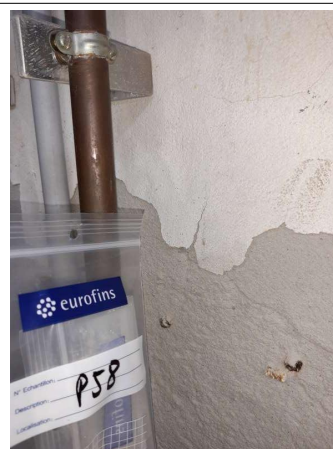
Prélèvement - P058 : RDC / 221.00.49 - Enduit- (Absence d'amiante)
