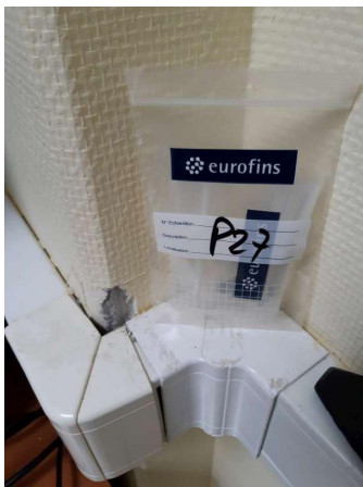
Prélèvement - P027 : RDC / 221.00.29 - Enduit- (Absence d'amiante)
