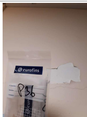
Prélèvement - P036 : RDC / 221.00.41 - Enduit- (Absence d'amiante)
