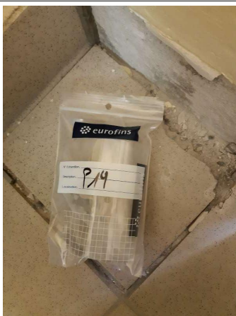
Prélèvement - P019 : RDC / 221.00.46 - Colle- (Absence d'amiante)
