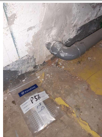
Prélèvement - P056 : RDC / 221.00.49 - Enduit- (Absence d'amiante)
