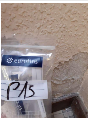
Prélèvement - P015 : RDC / 221.00.01 CIRCULATION - Peinture- (Absence d'amiante)
