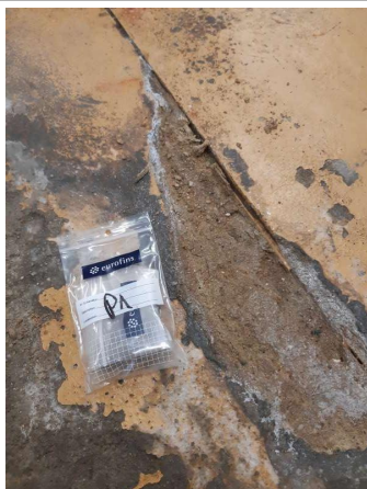
Prélèvement - P001 : RDC / 221.00.47 - Ragréage- (Absence d'amiante)
