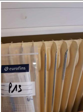
Prélèvement - P013 : R+1 / 221.01.47d - Peinture- (Absence d'amiante)
