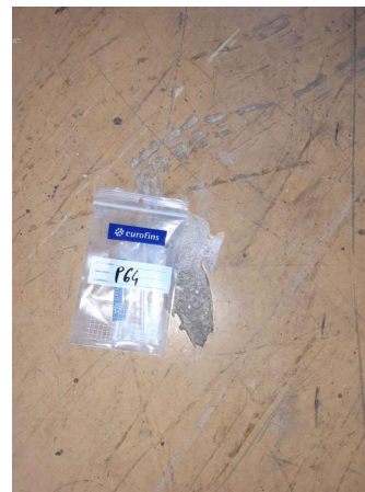
Prélèvement - P064 : RDC / 221.00.50 - Ragréage- (Absence d'amiante)
