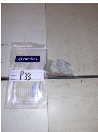
Prélèvement - P033 : RDC / 221.00.27 bis - Colle- (Présence d'amiante)
