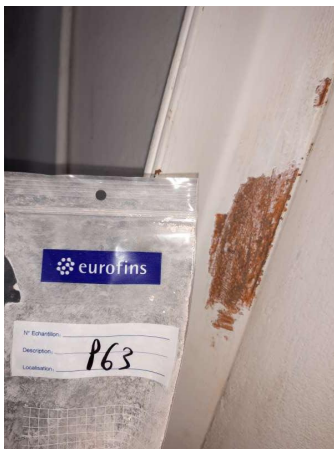
Prélèvement - P063 : RDC / 221.00.49 - Peinture- (Absence d'amiante)
