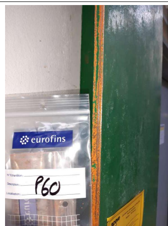
Prélèvement - P060 : RDC / 221.00.49 - Peinture- (Absence d'amiante)
