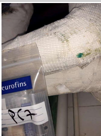
Prélèvement - P057 : RDC / 221.00.49 - Calorifugeage- (Absence d'amiante)
