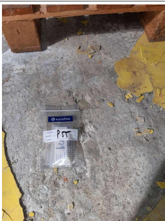
Prélèvement - P055 : RDC / 221.00.49 - Ragréege- (Absence d'amiante)
