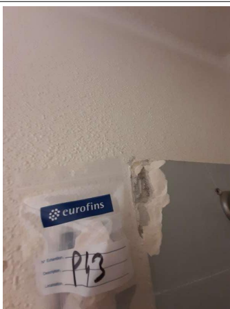
Prélèvement - P043 : RDC / 221.00.23 bis - Colle- (Absence d'amiante)
