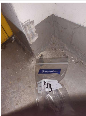
Prélèvement - P053 : RDC / 221.00.03 CIRCULATION - Ragréege- (Absence d'amiante)
