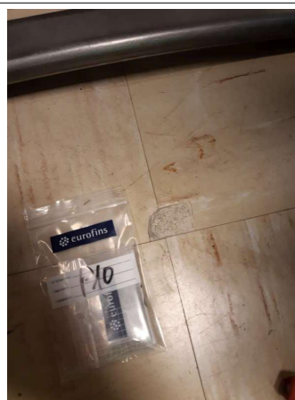
Prélèvement - P010 : R+1 / 221.01.47d - Colle- (Présence d'amiante)
