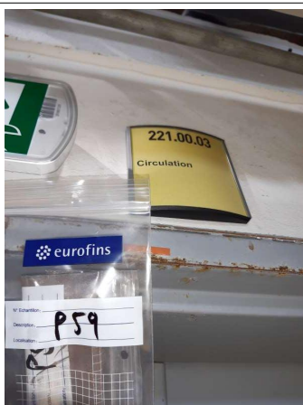
Prélèvement - P059 : RDC / 221.00.49 - Peinture- (Absence d'amiante)
