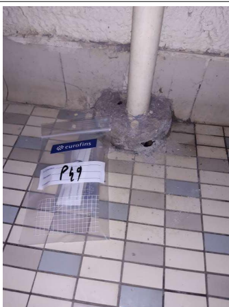
Prélèvement - P049 : RDC / 221.00.21 - Fourreau- (Présence d'amiante)
