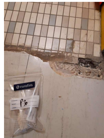
Prélèvement - P030 : RDC / 221.00.43 - Colle- (Absence d'amiante)
