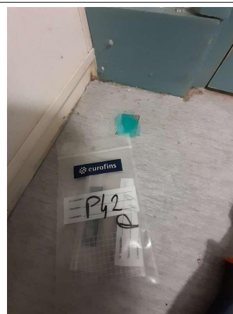
Prélèvement - P042 : RDC / 221.00.24 - Colle- (Absence d'amiante)
