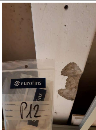
Prélèvement - P012 : R+1 / 221.01.47d - Enduit- (Absence d'amiante)
