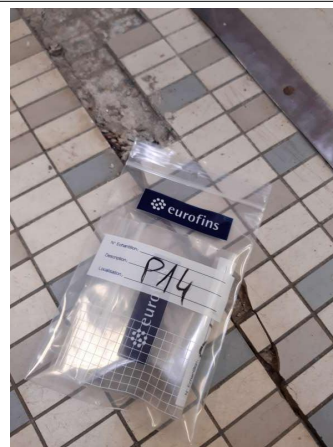
Prélèvement - P014 : RDC / 221.00.01 CIRCULATION - Colle- (Absence d'amiante)
