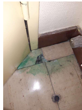
Prélèvement - P028 : RDC / 221.00.29 - Colle- (Présence d'amiante)
