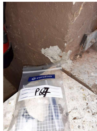
Prélèvement - P067 : RDC / 221.00.59 - Enduit- (Absence d'amiante)
