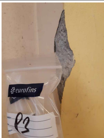
Prélèvement - P003 : RDC / 221.00.47 - Enduit- (Absence d'amiante)
