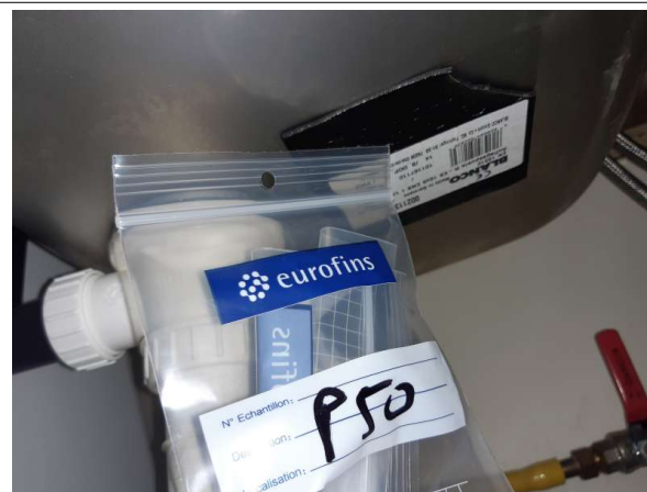
Prélèvement - P050 : RDC / 221.00.24 bis - Plaque bitumineuse- (Absence d'amiante)
