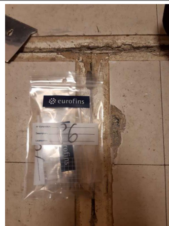
Prélèvement - P006 : R+1 / 221.01.47 - Colle- (Absence d'amiante)
