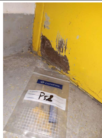
Prélèvement - P052 : RDC / 221.00.03 CIRCULATION - Peinture- (Absence d'amiante)
