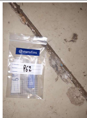
Prélèvement - P062 : RDC / 221.00.56 - Ragréage- (Absence d'amiante)
