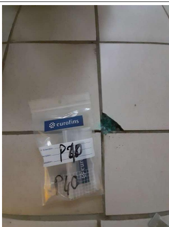
Prélèvement - P040 : RDC / 221.00.25 - Colle- (Absence d'amiante)
