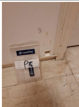
Prélèvement - P008 : R+1 / 221.01.47 - Enduit- (Absence d'amiante)
