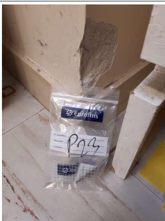
Prélèvement - P023 : RDC / 221.00.31 - Enduit- (Absence d'amiante)
