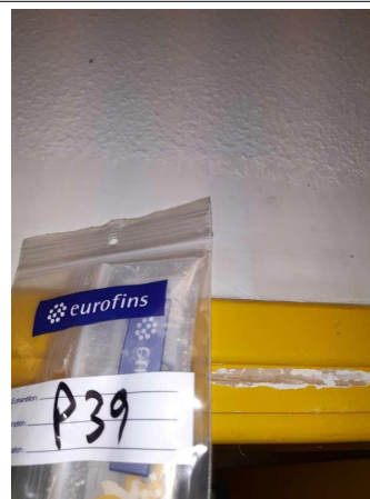
Prélèvement - P039 : RDC / 221.00.40 - Peinture- (Absence d'amiante)
