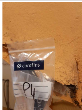
Prélèvement - P004 : RDC / 221.00.47 - Revêtement- (Absence d'amiante)
