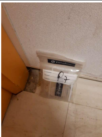
Prélèvement - P007 : R+1 / 221.01.47 - Colle- (Présence d'amiante)
