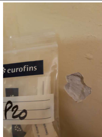
Prélèvement - P020 : RDC / 221.00.46 - Enduit- (Absence d'amiante)
