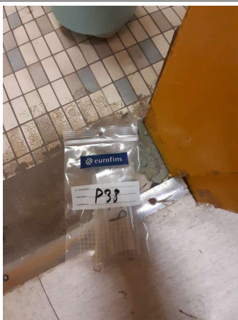
Prélèvement - P038 : RDC / 221.00.40 - Ragréage- (Absence d'amiante)
