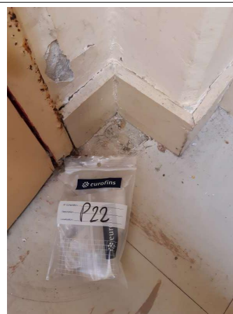
Prélèvement - P022 : RDC / 221.00.31 - Colle- (Présence d'amiante)
