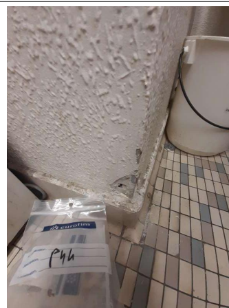
Prélèvement - P044 : RDC / 221.00.23 - Enduit- (Absence d'amiante)
