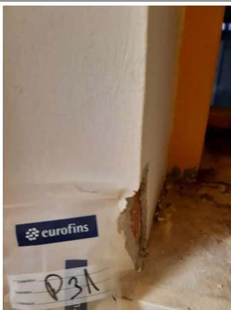
Prélèvement - P031 : RDC / 221.00.43 - Enduit- (Absence d'amiante)
