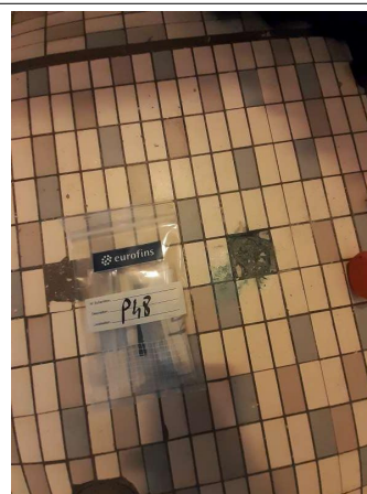
Prélèvement - P048 : RDC / 221.00.21 - Colle- (Absence d'amiante)
