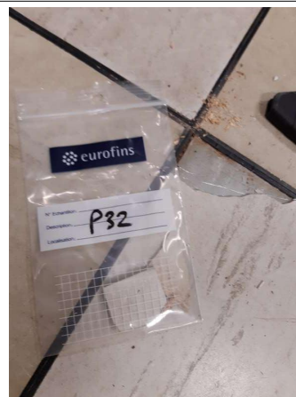
Prélèvement - P032 : RDC / 221.00.27 bis - Colle- (Présence d'amiante)
