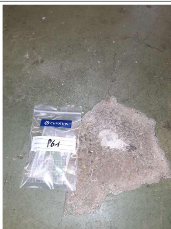
Prélèvement - P061 : RDC / 221.00.51 - Ragréage- (Absence d'amiante)
