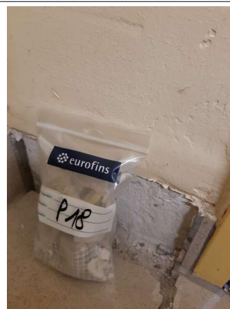
Prélèvement - P018 : RDC / 221.00.46 - Colle- (Absence d'amiante)
