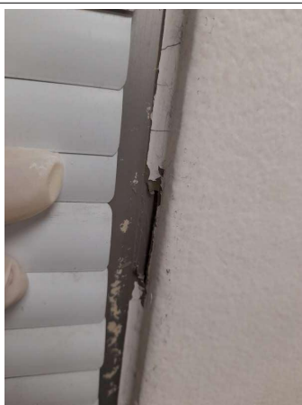
Prélèvement - P075 : COUR D'APPEL / R+0 / Pièce 15 - Joint- (Absence d'amiante)
