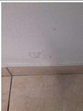
Prélèvement - P233 : COUR D'APPEL / R+1 / Pièce 43 - Enduit - (Présence d'amiante)
