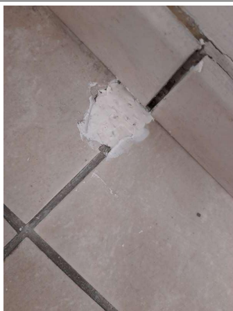
Prélèvement - P181 : COUR D'APPEL / R+1 / Pièce 32 - Colle de carrelage- (Absence d'amiante)
