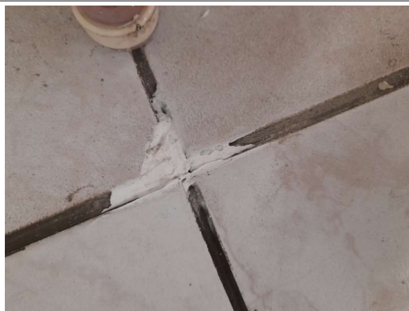
Prélèvement - P086 : COUR D'APPEL / R+0 / Pièce 18 - Colle de carrelage- (Absence d'amiante)
