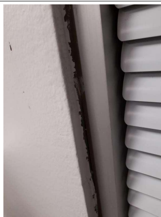
Prélèvement - P090 : COUR D'APPEL / R+0 / Pièce 18 - Joint- (Absence d'amiante)
