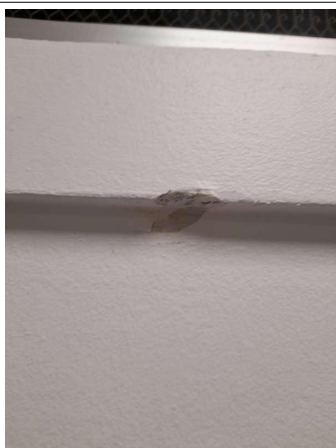
Prélèvement - P029 : COUR D'APPEL / R+0 / Pièce 06 - Enduit - (Présence d'amiante)
