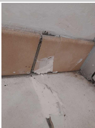
Prélèvement - P057 : COUR D'APPEL / R+0 / Pièce 12 - Colle de plinthe- (Absence d'amiante)
