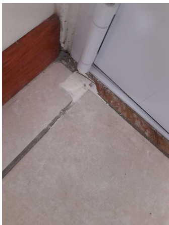
Prélèvement - P241 : COUR D'APPEL / R+1 / Pièce 45 - Colle de carrelage- (Absence d'amiante)
