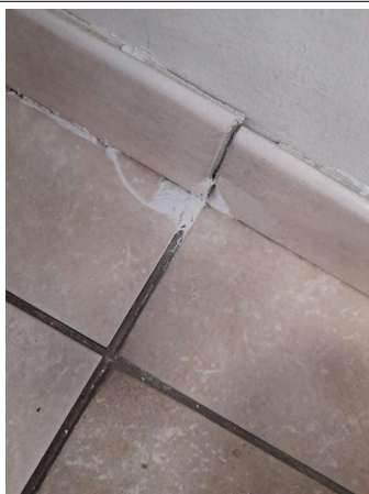
Prélèvement - P291 : COUR D'APPEL / R+1 / Pièce 55 - Colle de carrelage- (Absence d'amiante)
