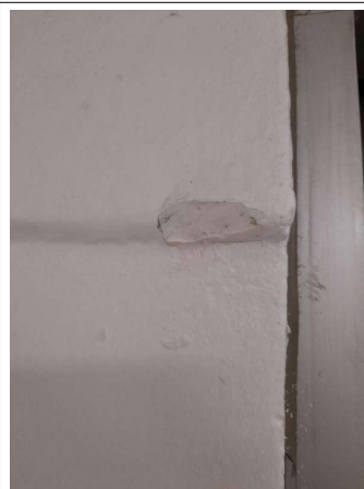
Prélèvement - P024 : COUR D'APPEL / R+0 / Pièce 05 - Enduit - (Présence d'amiante)
