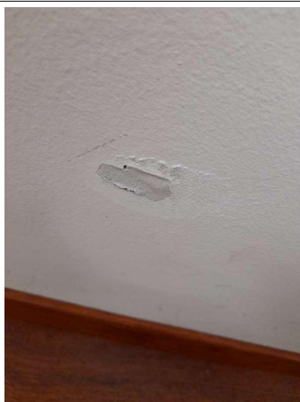
Prélèvement - P318 : COUR D'APPEL / R+1 / Pièce 60 - Enduit - (Présence d'amiante)
