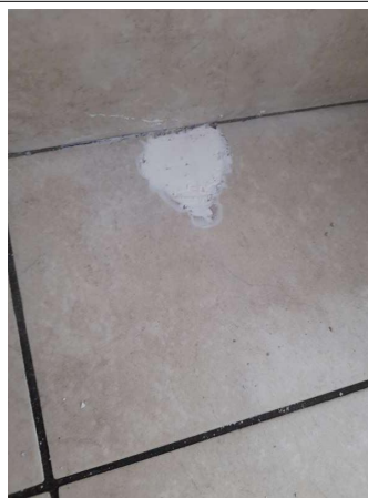
Prélèvement - P206 : COUR D'APPEL / R+1 / Pièce 38 - Colle de carrelage- (Absence d'amiante)
