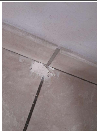
Prélèvement - P176 : COUR D'APPEL / R+1 / Pièce 31 - Colle de carrelage- (Absence d'amiante)
