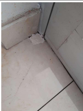
Prélèvement - P221 : COUR D'APPEL / R+1 / Pièce 41 - Colle de carrelage- (Absence d'amiante)
