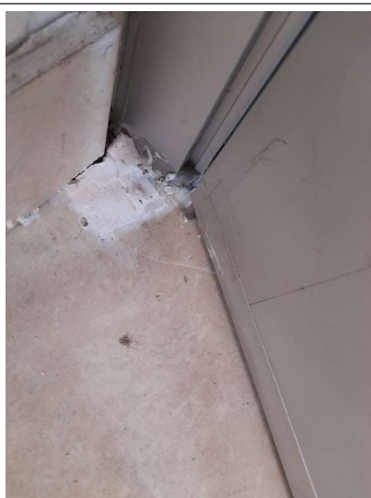
Prélèvement - P231 : COUR D'APPEL / R+1 / Pièce 43 - Colle de carrelage- (Absence d'amiante)
