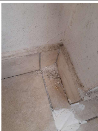
Prélèvement - P047 : COUR D'APPEL / R+0 / Pièce 10 - Colle de plinthe- (Présence d'amiante)
