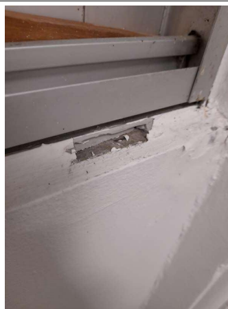
Prélèvement - P080 : COUR D'APPEL / R+0 / Pièce 16 - Joint- (Absence d'amiante)
