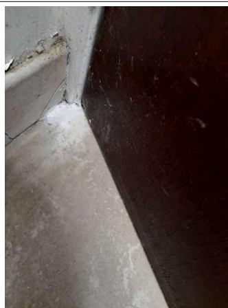
Prélèvement - P186 : COUR D'APPEL / R+0 / Pièce 33 - Colle de carrelage- (Absence d'amiante)
