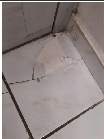
Prélèvement - P091 : COUR D'APPEL / R+0 / Pièce 19 - Colle de carrelage- (Absence d'amiante)
