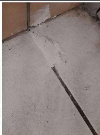
Prélèvement - P056 : COUR D'APPEL / R+0 / Pièce 12 - Colle de carrelage- (Absence d'amiante)
