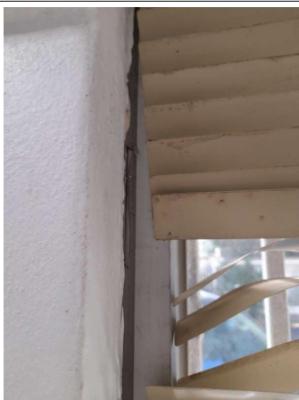
Prélèvement - P130 : COUR D'APPEL / R+0 / Pièce 25 - Joint- (Absence d'amiante)
