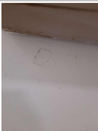
Prélèvement - P003 : COUR D'APPEL / R+0 / Pièce 01 - Enduit - (Présence d'amiante)
