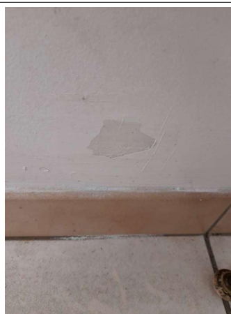
Prélèvement - P058 : COUR D'APPEL / R+0 / Pièce 12 - Enduit - (Absence d'amiante)
