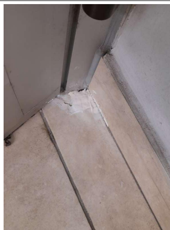
Prélèvement - P236 : COUR D'APPEL / R+1 / Pièce 44 - Colle de carrelage- (Absence d'amiante)
