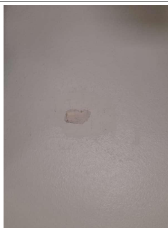
Prélèvement - P264 : COUR D'APPEL / R+1 / Pièce 49 - Enduit - (Présence d'amiante)
