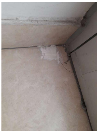
Prélèvement - P201 : COUR D'APPEL / R+1 / Pièce 37 - Colle de carrelage- (Absence d'amiante)
