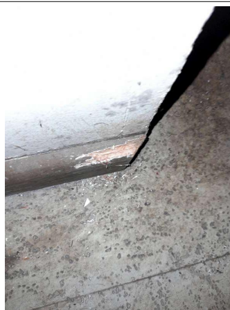
Prélèvement - P192 : COUR D'APPEL / R+0 / Pièce 34 - Peinture- (Absence d'amiante)
