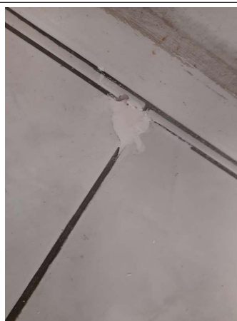
Prélèvement - P166 : COUR D'APPEL / R+1 / Pièce 29 - Colle de carrelage- (Absence d'amiante)
