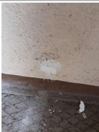
Prélèvement - P153 : COUR D'APPEL / R+0 / Rangement - Enduit- (Absence d'amiante)
