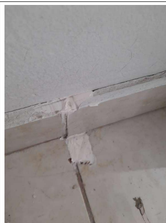
Prélèvement - P137 : COUR D'APPEL / R+0 / Pièce 27 - Colle de plinthe- (Absence d'amiante)
