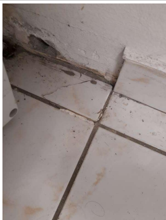
Prélèvement - P001 : COUR D'APPEL / R+0 / Pièce 01 - Colle de carrelage- (Absence d'amiante)
