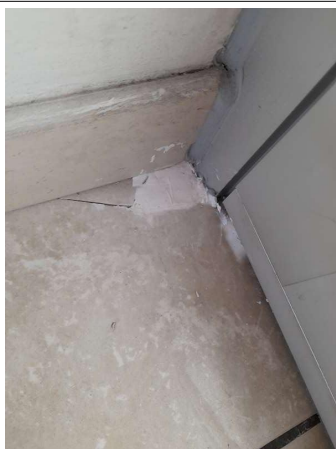
Prélèvement - P211 : COUR D'APPEL / R+1 / Pièce 39 - Colle de carrelage- (Absence d'amiante)
