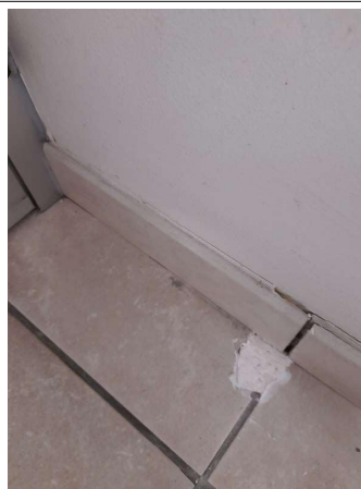
Prélèvement - P182 : COUR D'APPEL / R+1 / Pièce 32 - Colle de plinthe- (Absence d'amiante)
