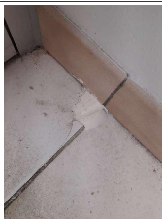
Prélèvement - P076 : COUR D'APPEL / R+0 / Pièce 16 - Colle de carrelage- (Absence d'amiante)
