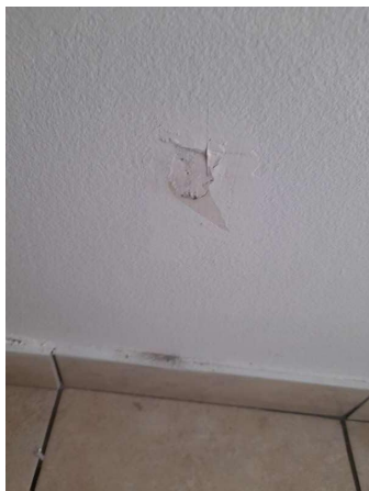
Prélèvement - P203 : COUR D'APPEL / R+1 / Pièce 37 - Enduit - (Présence d'amiante)
