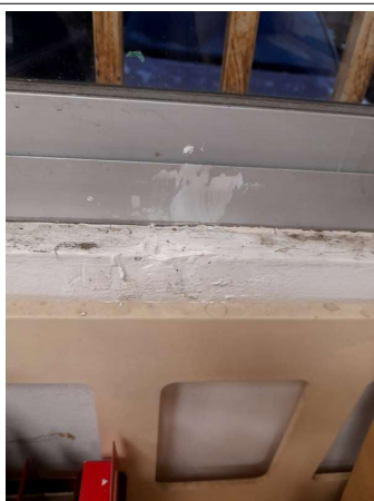
Prélèvement - P069 : COUR D'APPEL / R+0 / Pièce 14 - Enduit - (Absence d'amiante)
