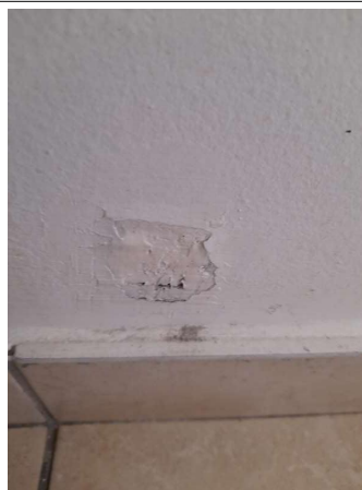
Prélèvement - P218 : COUR D'APPEL / R+1 / Pièce 40 - Enduit - (Présence d'amiante)
