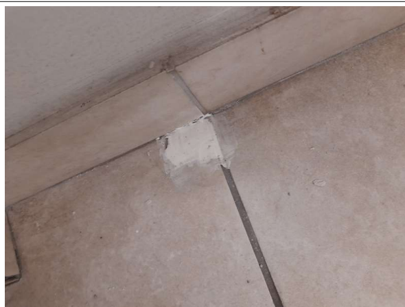
Prélèvement - P036 : COUR D'APPEL / R+0 / Pièce 08 - Colle de carrelage- (Absence d'amiante)
