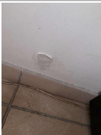
Prélèvement - P328 : COUR D'APPEL / R+0 / Pièce 63 - Enduit - (Absence d'amiante)
