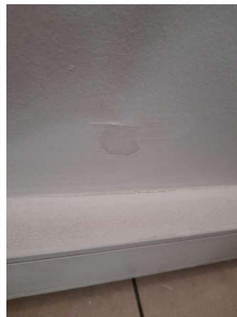
Prélèvement - P204 : COUR D'APPEL / R+1 / Pièce 37 - Enduit - (Présence d'amiante)
