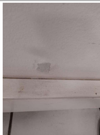
Prélèvement - P284 : COUR D'APPEL / R+1 / Pièce 53 - Enduit - (Présence d'amiante)
