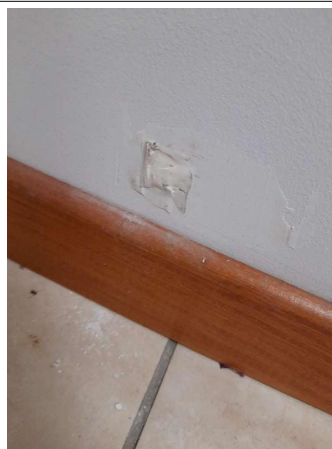
Prélèvement - P008 : COUR D'APPEL / R+0 / Pièce 02 - Enduit - (Absence d'amiante)
