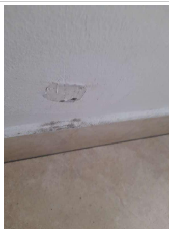
Prélèvement - P208 : COUR D'APPEL / R+1 / Pièce 38 - Enduit - (Présence d'amiante)
