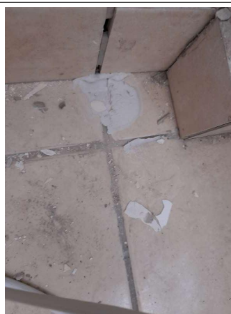
Prélèvement - P321 : COUR D'APPEL / R+0 / Pièce 62 - Colle de carrelage- (Absence d'amiante)
