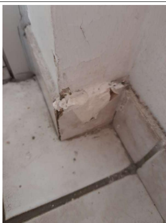
Prélèvement - P087 : COUR D'APPEL / R+0 / Pièce 18 - Colle de plinthe- (Présence d'amiante)
