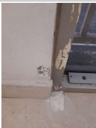
Prélèvement - P009 : COUR D'APPEL / R+0 / Pièce 02 - Enduit - (Présence d'amiante)
