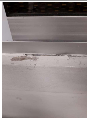
Prélèvement - P240 : COUR D'APPEL / R+1 / Pièce 44 - Joint- (Absence d'amiante)
