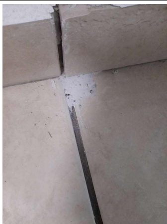
Prélèvement - P261 : COUR D'APPEL / R+1 / Pièce 49 - Colle de carrelage- (Absence d'amiante)
