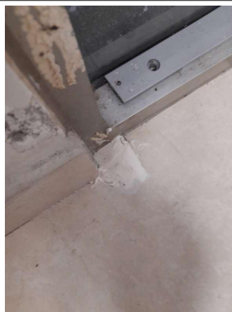
Prélèvement - P006 : COUR D'APPEL / R+0 / Pièce 02 - Colle de carrelage- (Absence d'amiante)
