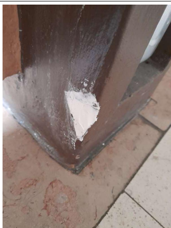
Prélèvement - P147 : COUR D'APPEL / R+1 / Coursives - Enduit- (Présence d'amiante)
