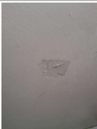
Prélèvement - P053 : COUR D'APPEL / R+0 / Pièce 11 - Enduit - (Absence d'amiante)
