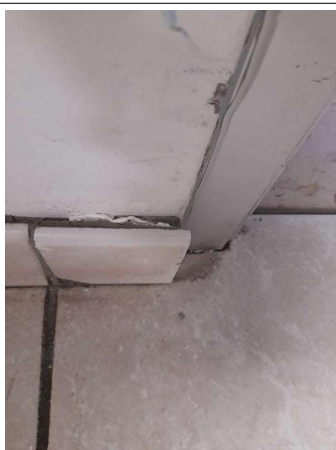
Prélèvement - P177 : COUR D'APPEL / R+1 / Pièce 31 - Colle de plinthe- (Présence d'amiante)
