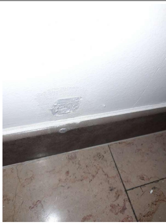
Prélèvement - P199 : COUR D'APPEL / R+1 / Pièce 35 - Plaque- (Absence d'amiante)
