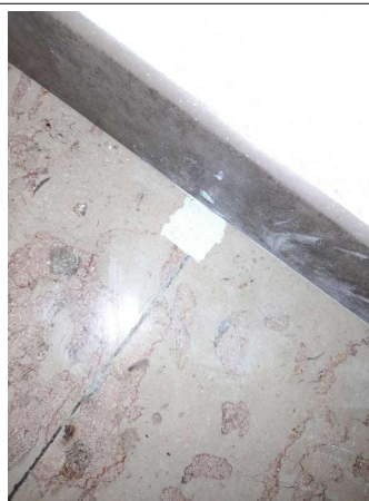
Prélèvement - P196 : COUR D'APPEL / R+1 / Pièce 35 - Colle de carrelage- (Absence d'amiante)
