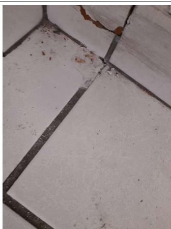
Prélèvement - P281 : COUR D'APPEL / R+1 / Pièce 53 - Colle de carrelage- (Absence d'amiante)
