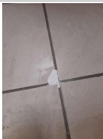
Prélèvement - P106 : COUR D'APPEL / R+0 / Pièce 22 - Colle de carrelage- (Absence d'amiante)
