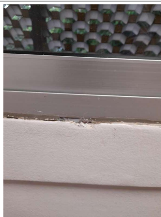
Prélèvement - P290 : COUR D'APPEL / R+1 / Pièce 54 - Joint- (Absence d'amiante)
