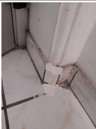
Prélèvement - P067 : COUR D'APPEL / R+0 / Pièce 14 - Colle de plinthe- (Absence d'amiante)
