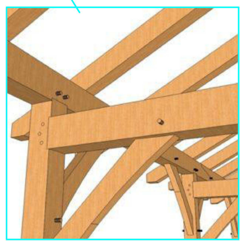
Principe de jarret ancrage/vis+boulons
