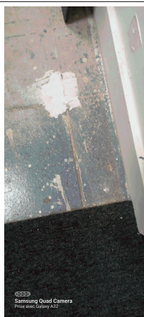
Prélèvement - P069 : Niveau 2/3 / Palier - Colle- (Absence d'amiante)
