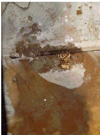
Prélèvement - P010 : Niveau 2/3 / Combles A1 / Sas - Colle, Ragréage- (Absence d'amiante)
