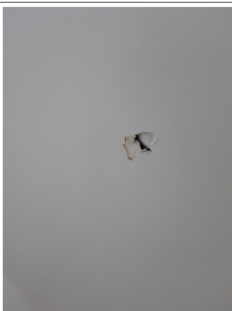
Prélèvement - P016 : Niveau 2/3 / Combles A1 / Plateau de bureau - Plaque- (Absence d'amiante)
