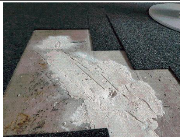
Prélèvement - P034 : Niveau 4/5 / Combles C2 / Bureau 1 - Enduit- (Absence d'amiante)
