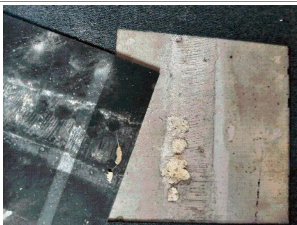
Prélèvement - P022 : Niveau 2/3 / Combles A1 / Plateau de bureau - Ragréage- (Absence d'amiante)
