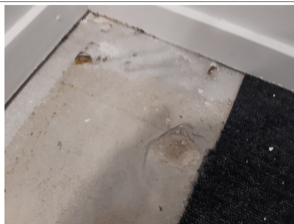
Prélèvement - P029 : Niveau 4/5 / Palier d'ascenseur - Chape maigre- (Absence d'amiante)
