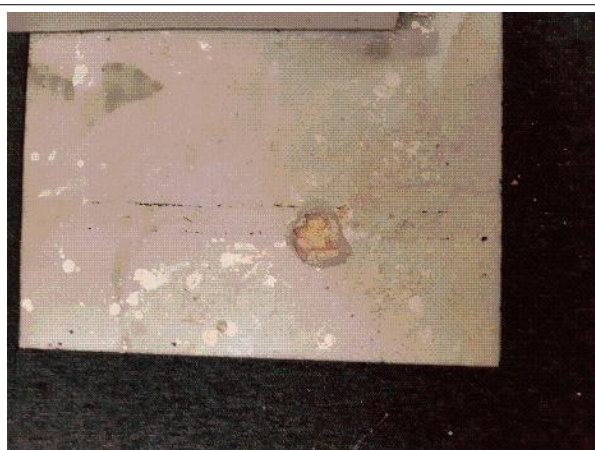
Prélèvement - P005 : Niveau 2/3 / Combles A1 / Local 2 - Colle, Ragréage- (Absence d'amiante)
