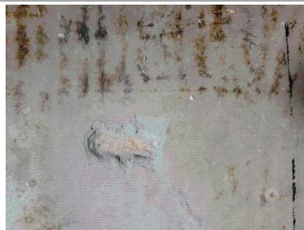
Prélèvement - P002 : Niveau 2/3 / Combles A1 / Bureau 1 - Ragréage, Primaire d'accrochage- (Absence d'amiante)
