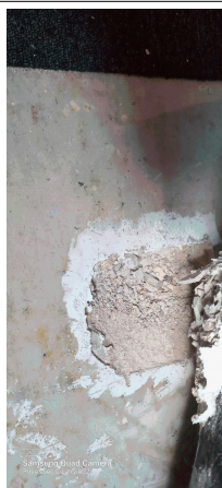
Prélèvement - P064 : Niveau 2/3 / Combles A1 / Bureau 1 - Colle- (Absence d'amiante)
