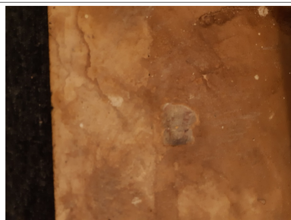
Prélèvement - P004 : Niveau 2/3 / Combles A1 / Sas - Colle- (Présence d'amiante)
