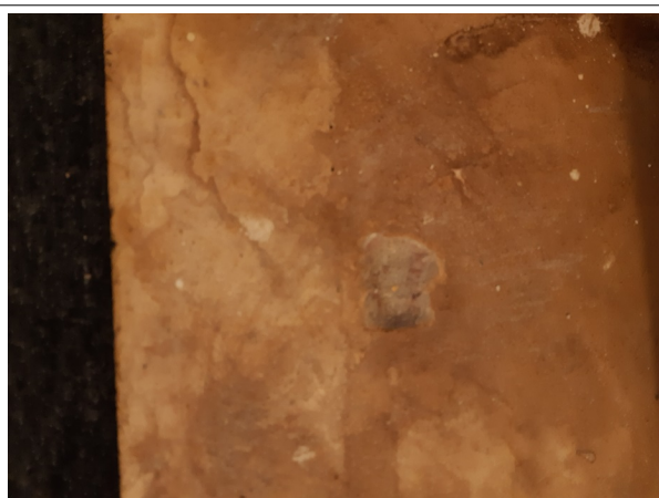
Prélèvement - P003 : Niveau 2/3 / Combles A1 / Sas - Colle, Ragréage- (Absence d'amiante)
