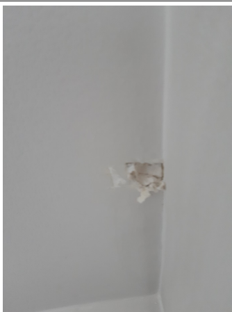
Prélèvement - P026 : Niveau 2/3 / Combles A1 / Réserve - Plaque, Bande de plaque de plâtre- (Absence d'amiante)
