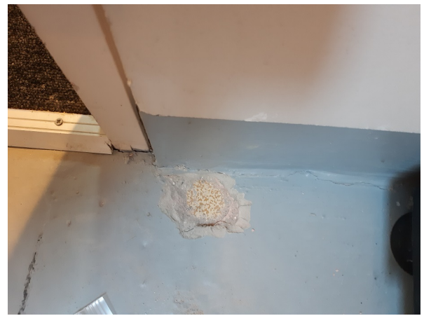
Prélèvement - P008 : Niveau 2/3 / Combles A1 / Local 1 - Ragréage- (Absence d'amiante)
