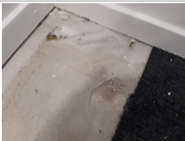
Prélèvement - P028 : Niveau 4/5 / Palier d'ascenseur - Colle, Ragréage- (Absence d'amiante)
