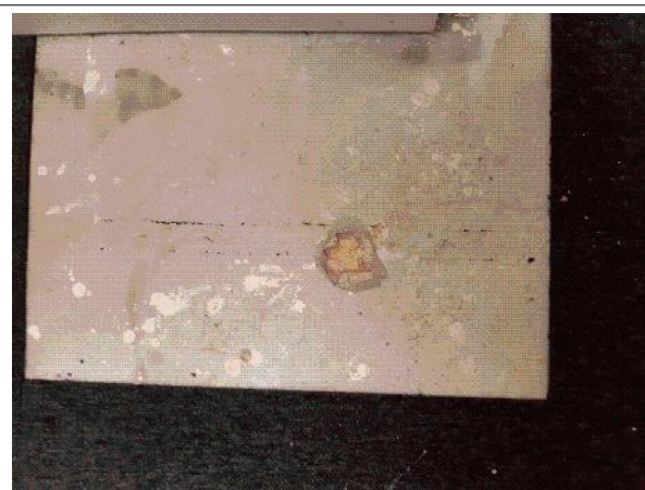
Prélèvement - P006 : Niveau 2/3 / Combles A1 / Local 2 - Ragréage, Primaire d'accrochage- (Absence d'amiante)
