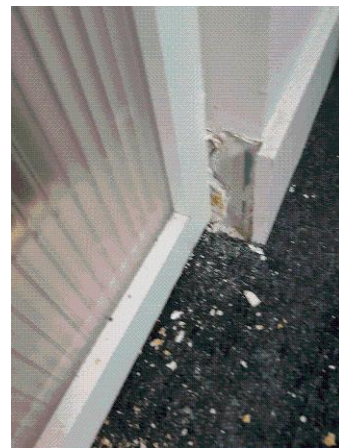
Prélèvement - P011 : Niveau 2/3 / Combles A1 / Plateau de bureau - Colle de plinthe- (Absence d'amiante)
