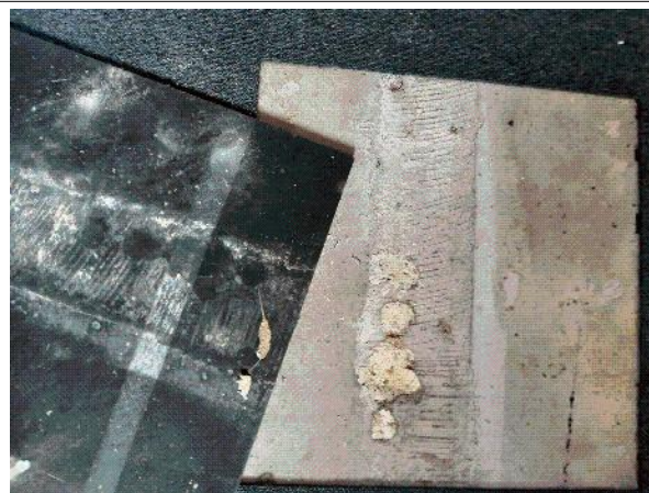
Prélèvement - P021 : Niveau 2/3 / Combles A1 / Plateau de bureau - Colle- (Absence d'amiante)
