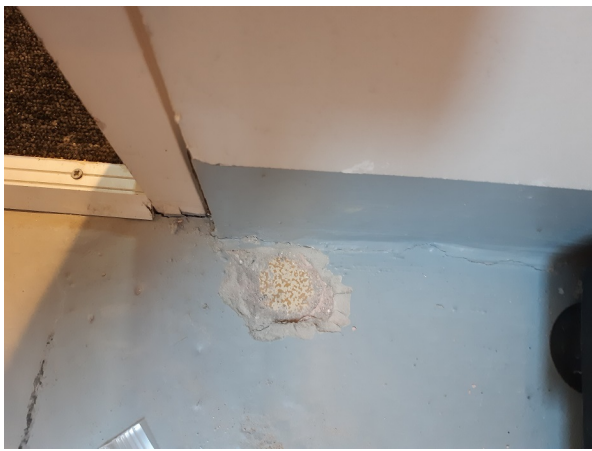
Prélèvement - P007 : Niveau 2/3 / Combles A1 / Local 1 - Ragréage, Peinture- (Absence d'amiante)
