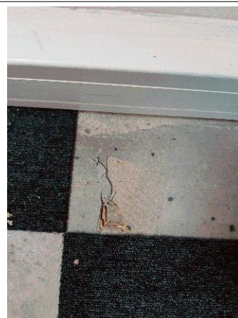
Prélèvement - P019 : Niveau 2/3 / Combles A1 / Plateau de bureau - Colle- (Absence d'amiante)
