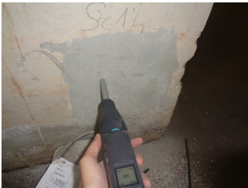
Scléromètre en action
