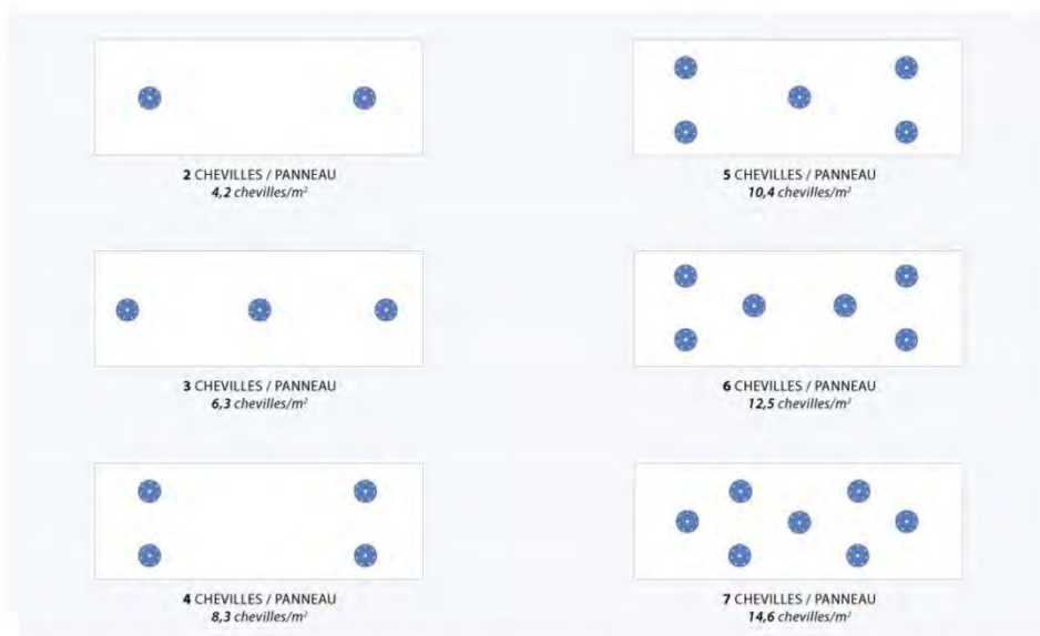
Figure 2a : Panneaux FKD-MAX C2 de dimensions 1200 x 400 mm et rosace de Ø 60 mm plans de chevillage « en plein » (espacement entre chevilles ≥ 150 mm)
