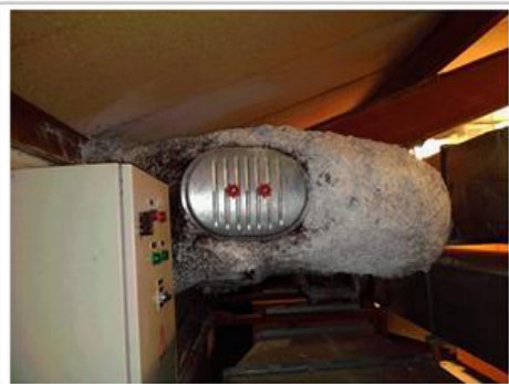
Prélèvement - P011 : R+1 / AILE E / L108 - Flocage- (Absence d'amiante)
