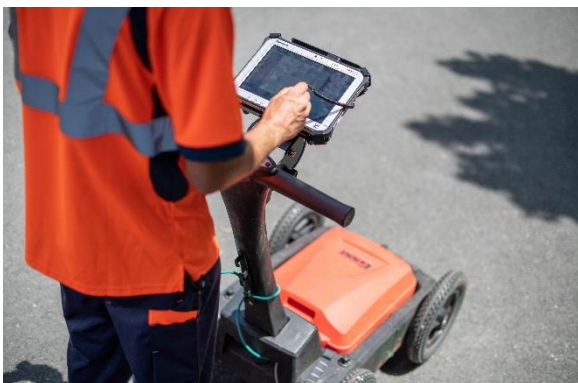
Figure 2 : Géoradar GSSI DF 300-800
