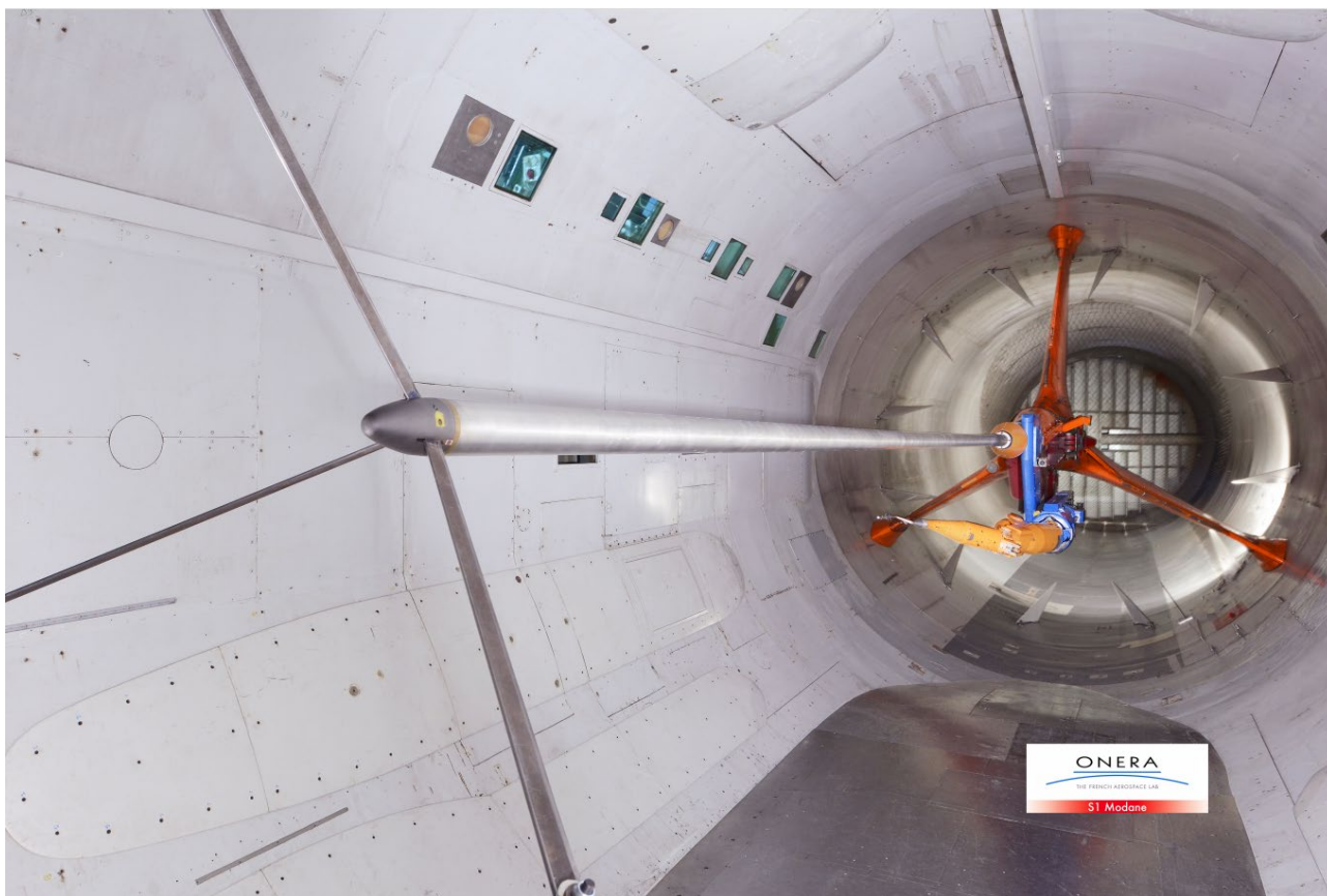
Figure 2 : Vue d'une veine d'essai typique de la soufflerie S1MA, le vent circule du premier plan vers le second plan. La rangée de hublots visibles se situe à droite sens pilote.
