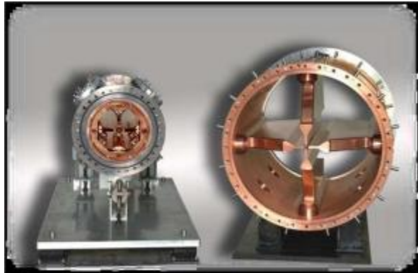
Figure 3 : Section de 2 types de cavité RFQ et cavité complète et intégrée sur sa ligne (RFQ SPIRAL 2 au GANIL)
