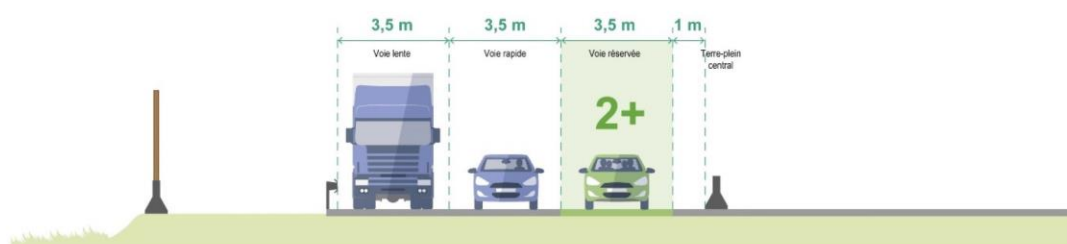
Figure 1 : Coupe schématique du scénario « VR2+ » correspondant aux variantes 1, 1bis et 2 (Source : FRANCOM)
