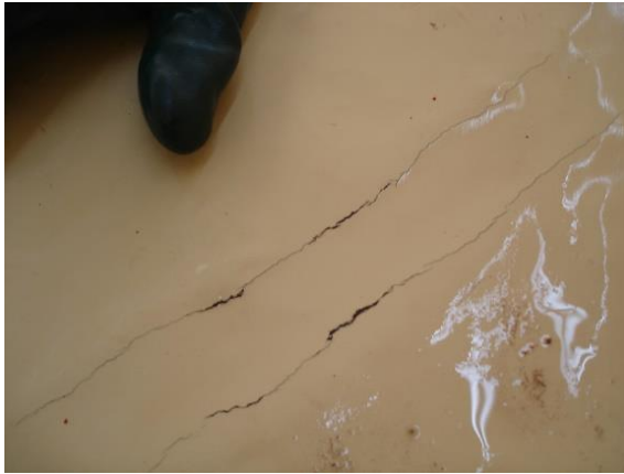
Photos du Liner vieillissant :
