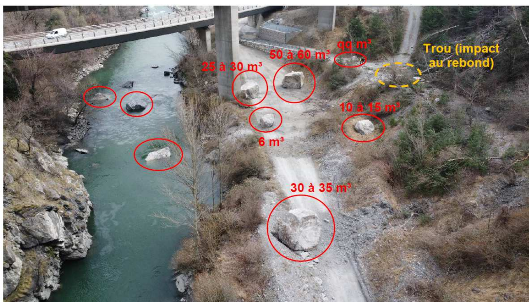
Figure 8 : Relevés des blocs éboulés sur la route communale et dans l'Isère (ONF-RTM, 18/03/2022)
