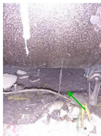
Matériaux : ZPSO-006 Prélèvement : P006 Description : Isolant intérieur fibreux sous baignoire Localisation : Rez de chaussée Logement 01 - SDB Résultat : Absence d'amiante
