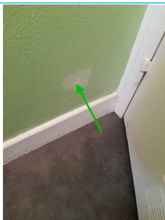
Matériaux : ZPSO-006 Prélèvement : P013 Description : Enduit à base de plâtre Localisation : Logement 03 RDC - SDB; Logement 03 RDC - WC Résultat : Absence d'amiante
