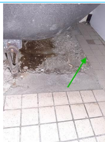
Matériaux : ZPSO-012 Prélèvement : P012 Description : Colle de carrelage Localisation : 2ème étage Logement 09 - SDB; 2ème étage Logement 09 - WC Résultat : Absence d'amiante
