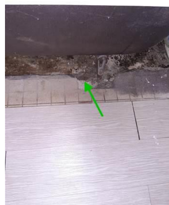
Matériaux : ZPSO-004 Prélèvement : P004 Description : Colle de carrelage Localisation : 1er étage Logement 03 - SDB; 1er étage Logement 03 - WC Résultat : Absence d'amiante
