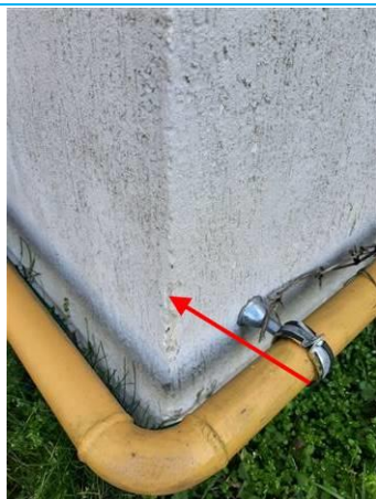
Matériaux : ZPSO-019 Prélèvement : P019 Description : Enduit extérieur + peinture Localisation : Extérieur - Façades bât 42-43 Résultat : Présence d'amiante
