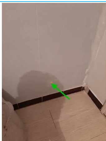
Matériaux : ZPSO-007 Prélèvement : P007 Description : Enduit à base de plâtre Localisation : 1er étage Logement 03 - SDB; 1er étage Logement 03 - WC Résultat : Absence d'amiante
