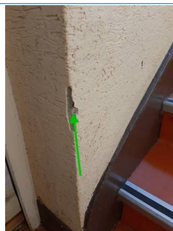
Matériaux : ZPSO-017 Prélèvement : P017 Description : Enduit à base de plâtre Localisation : 2ème étage - Parties communes Résultat : Absence d'amiante
