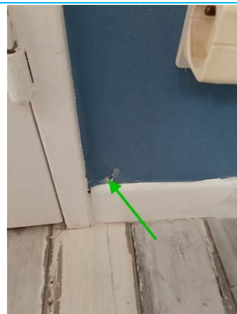
Matériaux : ZPSO-002 Prélèvement : P002 Description : Enduit à base de plâtre Localisation : 1er étage Logement 02 - SDB; 1er étage Logement 02 - WC Résultat : Absence d'amiante
