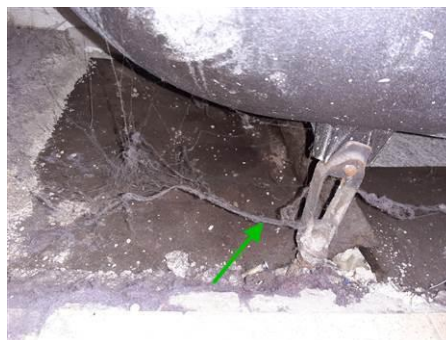
Matériaux : ZPSO-002 Prélèvement : P002 Description : Isolant intérieur fibreux sous baignoire Localisation : Rez de chaussée Logement 01 - SDB Résultat : Absence d'amiante
