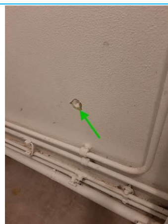
Matériaux : ZPSO-012 Prélèvement : P012 Description : Enduit à base de plâtre Localisation : Bâtiment 11 Logement 02 1er étage - SDB Résultat : Absence d'amiante
