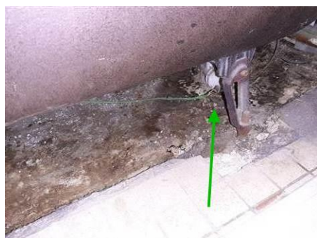
Matériaux : ZPSO-009 Prélèvement : P009 Description : Isolant intérieur fibreux sous baignoire Localisation : 1er étage Logement 03 - SDB Résultat : Absence d'amiante
