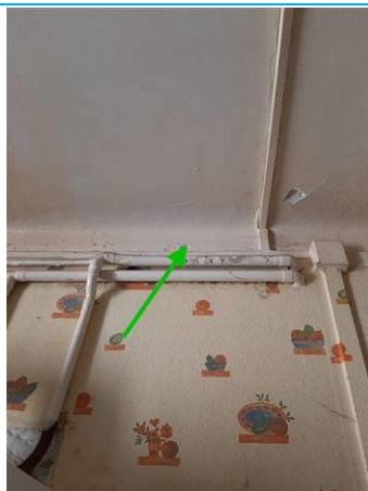
Matériaux : ZPSO-001 Prélèvement : P001 Description : Enduit à base de plâtre + peinture Localisation : 2ème étage - Cuisine Résultat : Absence d'amiante
