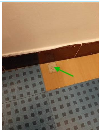
Matériaux : ZPSO-001 Prélèvement : P001 Description : Sous-couche de revêtement souple Localisation : 1er étage - SDB gauche Résultat : Absence d'amiante
