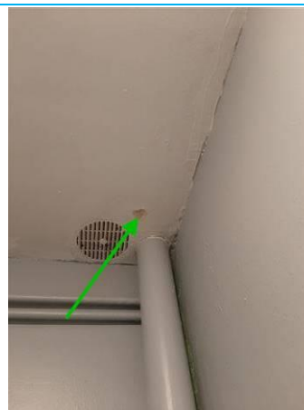
Matériaux : ZPSO-002 Prélèvement : P002 Description : Enduit à base de plâtre Localisation : Pavillon 38 RDC - WC Résultat : Absence d'amiante
