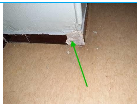
Matériaux : ZPSO-013 Prélèvement : P013 Description : Colle de plinthes marron Localisation : 2ème étage - SDB Résultat : Absence d'amiante
