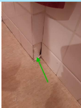
Matériaux : ZPSO-003 Prélèvement : P003 Description : Colle de faïence blanche Localisation : Logement 01 RDC - SDB Résultat : Absence d'amiante
