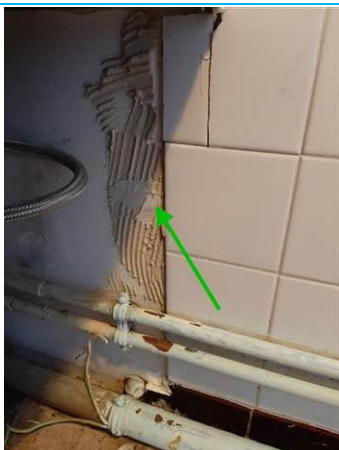
Matériaux : ZPSO-007 Prélèvement : P007 Description : Colle de faïence Localisation : 1er étage Logement 04 - SDB Résultat : Absence d'amiante
