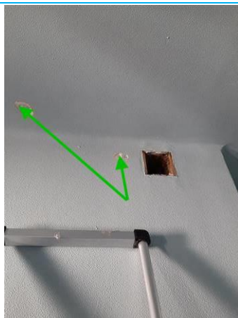
Matériaux : ZPSO-014 Prélèvement : P014 Description : Enduit à base de plâtre + peinture Localisation : 2ème étage - SDB Résultat : Absence d'amiante
