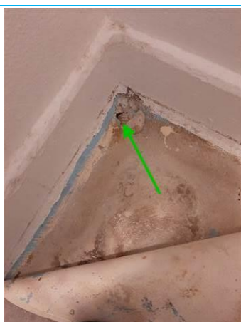
Matériaux : ZPSO-011 Prélèvement : P011 Description : Ragréage sous linoléum Localisation : Bâtiment 11 Logement 02 1er étage - SDB Résultat : Absence d'amiante
