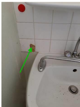
Matériaux : ZPSO-005 Prélèvement : P005 Description : Colle de faïence blanche Localisation : 2ème étage - Sanitaires Résultat : Absence d'amiante
