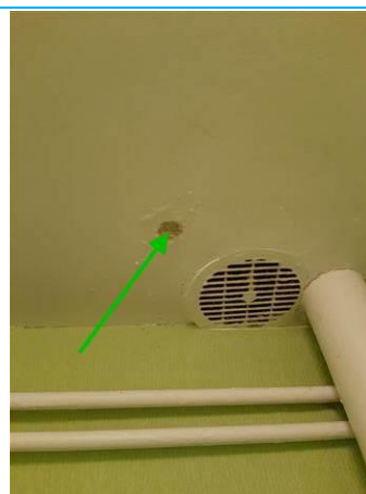
Matériaux : ZPSO-006 Prélèvement : P006 Description : Enduit à base de plâtre Localisation : Pavillon 37 RDC - WC Résultat : Absence d'amiante
