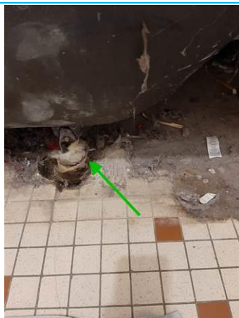
Matériaux : ZPSO-013 Prélèvement : P013 Description : Isolant intérieur fibreux sous baignoire Localisation : 1er étage Logement 04 - SDB Résultat : Absence d'amiante
