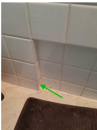
Matériaux : ZPSO-003 Prélèvement : P003 Description : Colle de faïence blanche Localisation : Logement 06 au RDC - SDB Résultat : Absence d'amiante
