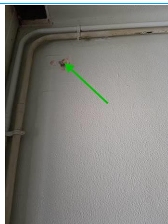
Matériaux : ZPSO-004 Prélèvement : P004 Description : Enduit à base de plâtre + peinture Localisation : 2ème étage - Sanitaires Résultat : Absence d'amiante
