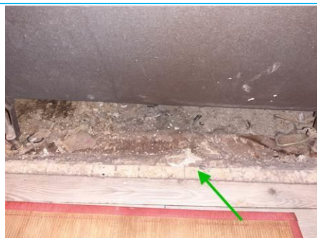
Matériaux : ZPSO-011 Prélèvement : P011 Description : Colle de carrelage Localisation : 1er étage Logement 03 - SDB; 1er étage Logement 03 - WC Résultat : Absence d'amiante
