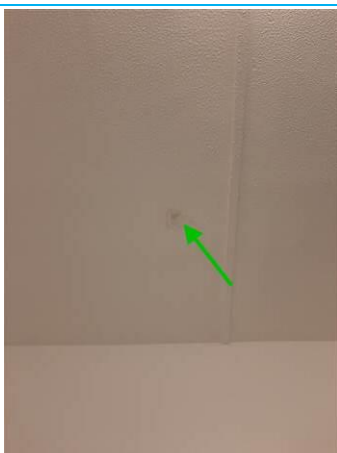
Matériaux : ZPSO-015 Prélèvement : P015 Description : Enduit à base de plâtre Localisation : Bâtiment 11 Logement 02 1er étage - SDB Résultat : Absence d'amiante
