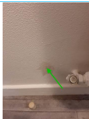
Matériaux : ZPSO-008 Prélèvement : P014 Description : Enduit à base de plâtre Localisation : Logement 8 1er étage - SDB; Logement 8 1er étage - WC Résultat : Absence d'amiante
