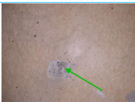
Matériaux : ZPSO-012 Prélèvement : P012 Description : Lino beige + ragréage sur carrelage Localisation : 2ème étage - SDB Résultat : Absence d'amiante
