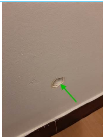
Matériaux : ZPSO-003 Prélèvement : P003 Description : Enduit à base de plâtre Localisation : 1er étage - SDB gauche Résultat : Absence d'amiante
