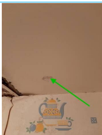
Matériaux : ZPSO-005 Prélèvement : P005 Description : Enduit à base de plâtre Localisation : Pavillon 37 RDC - Cuisine Résultat : Absence d'amiante
