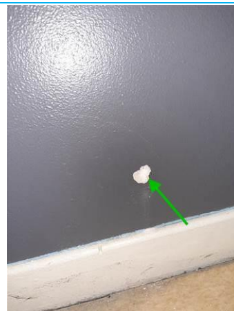
Matériaux : ZPSO-002 Prélèvement : P008 Description : Enduit à base de plâtre Localisation : Logement 7 RDC - SDB Résultat : Absence d'amiante
