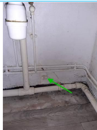
Matériaux : ZPSO-018 Prélèvement : P018 Description : Enduit à base de plâtre Localisation : Logement 02 au RDC - SDB Résultat : Absence d'amiante
