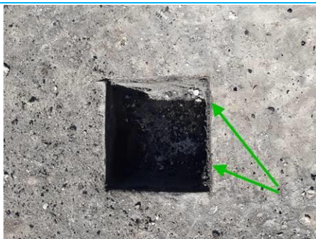
Matériaux : ZPSO-006 Prélèvement : P006 Description : Partie plane : revêtement bitumineux Localisation : Extérieur - Toiture bât 44 Résultat : Absence d'amiante
