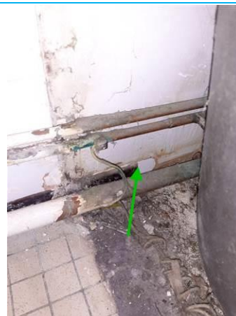
Matériaux : ZPSO-016 Prélèvement : P016 Description : Colle de plinthes noires Localisation : 2ème étage Logement 05 - SDB; 2ème étage Logement 05 - WC Résultat : Absence d'amiante
