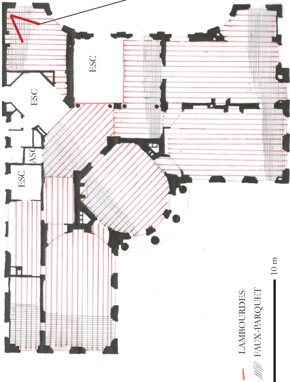
Schéma principe : Hypothèse de plan de parquet du RDC HAUT
