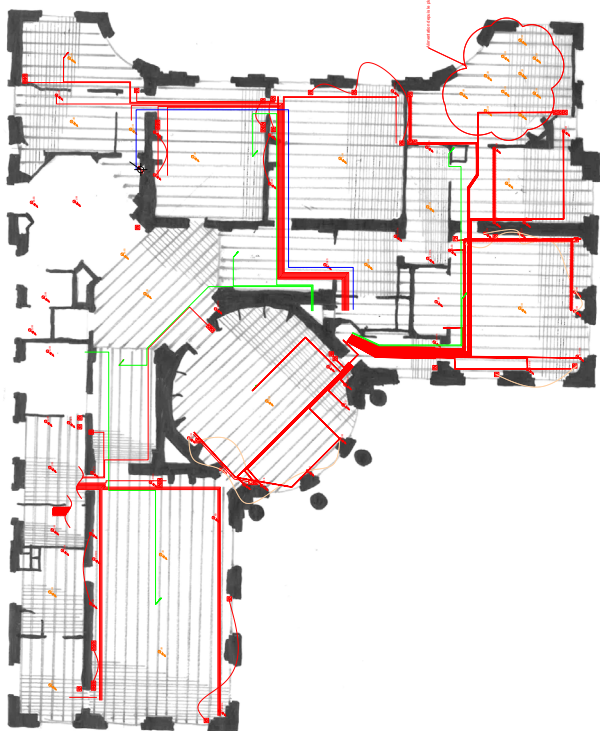
Schéma principe : Hypothèse de cheminement des réseaux en parquet du R+1
