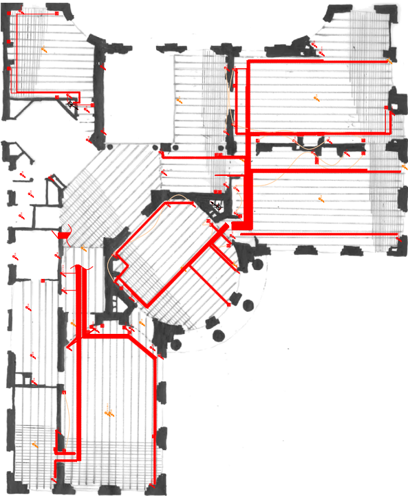
Schéma principe : Hypothèse de cheminement des réseaux en parquet du RDC HAUT
