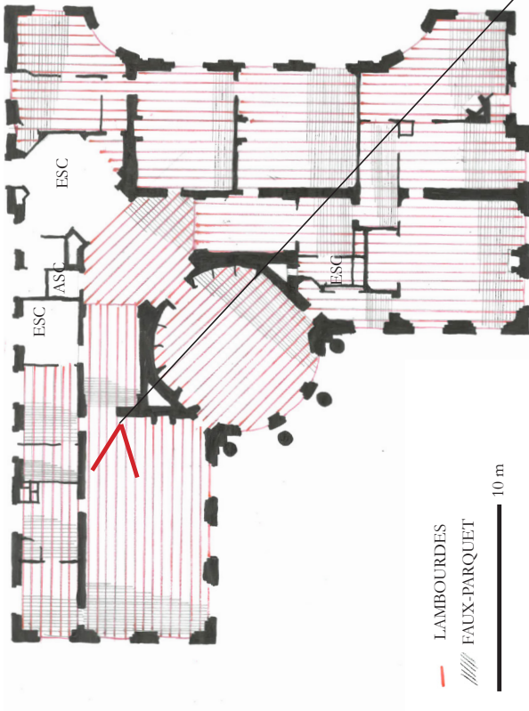
Schéma principe : Hypothèse de plan de parquet du R+1
