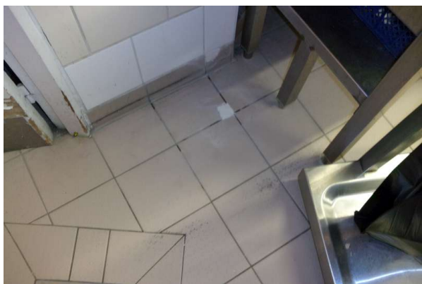
Prélèvement - P233 : R+2 / H216 - Colle de carrelage- (Absence d'amiante)
