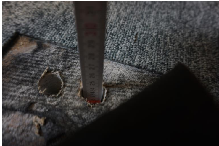
Détermination épaisseur dalle (environ 7.5 cm)
