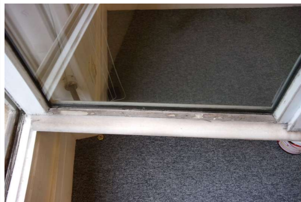
Prélèvement - P118 : R+1 / D109 - Joint de vitrage- (Absence d'amiante)
