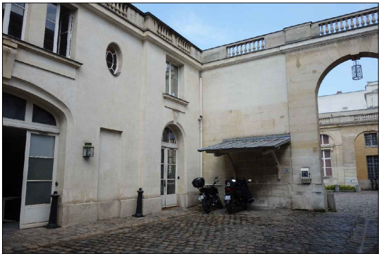
Détail façade courrette Est • Balustrade: salissures • Mur de clôture: remontée d'humidité, perte d'enduit
