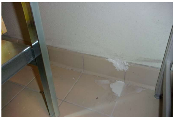
Prélèvement - P415 : R-1 / S18 / Réserve - Colle de plinthe- (Absence d'amiante)
