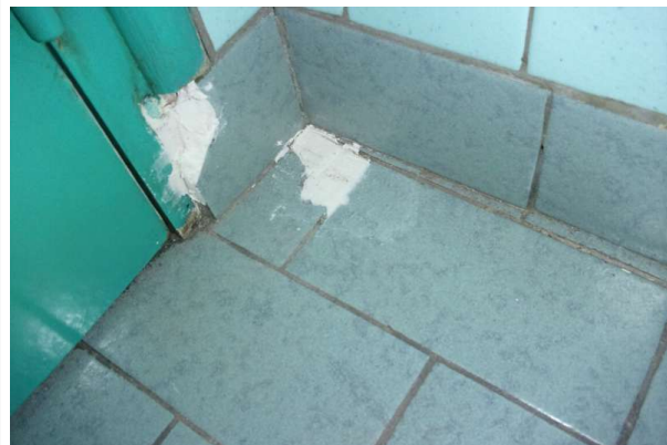
Prélèvement - P136 : R+1 / D138 - Colle de carrelage- (Absence d'amiante)
