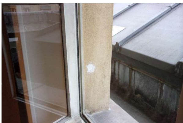
Prélèvement - P129 : R+1 / D104 - Enduit taloché- (Absence d'amiante)
