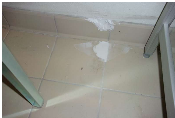
Prélèvement - P416 : R-1 / S18 / Réserve - Colle de carrelage- (Absence d'amiante)
