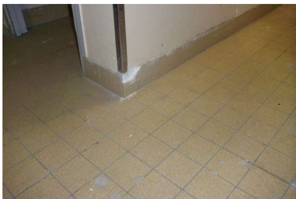
Prélèvement - P379 : R-1 / S12 - Colle de plinthe- (Absence d'amiante)
