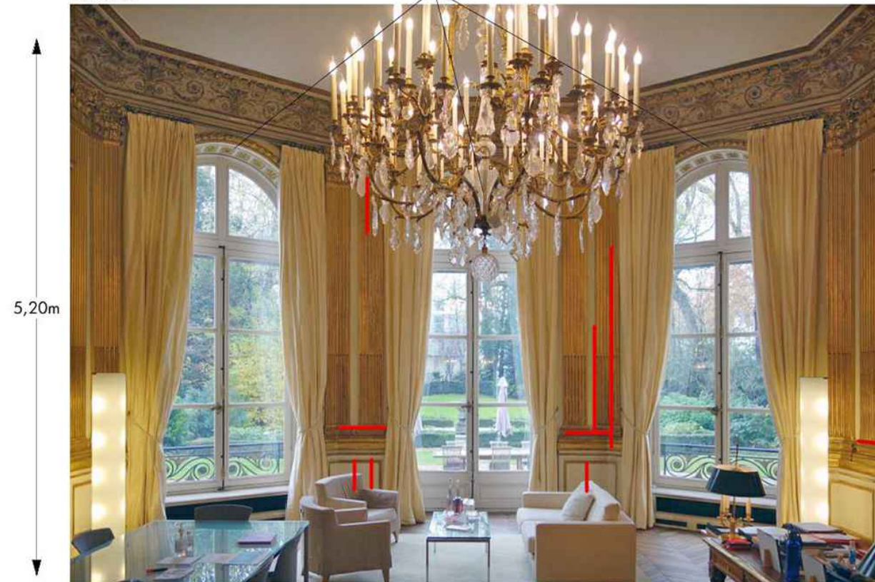
H23.L1 Ebrasements : Nombreuses fentes / joints ouverts / éclats Dépose des volets intérieurs / Restauration atelier
