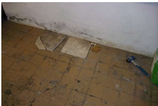
Prélèvement - P029 : R-1 / S10 - Colle de carrelage- (Absence d'amiante)
