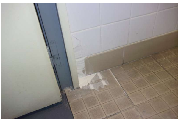
Prélèvement - P435 : R-1 / S4 - Colle de plinthe- (Absence d'amiante)
