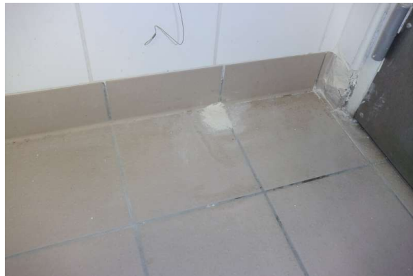
Prélèvement - P236 : R+2 / H216 - Colle de carrelage- (Absence d'amiante)
