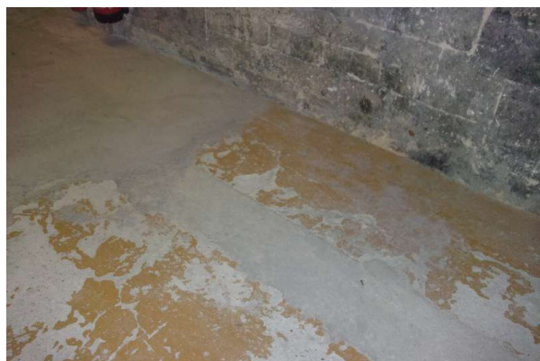
Prélèvement - P394 : R-1 / S15 - Enduit de ragréage- (Absence d'amiante)
