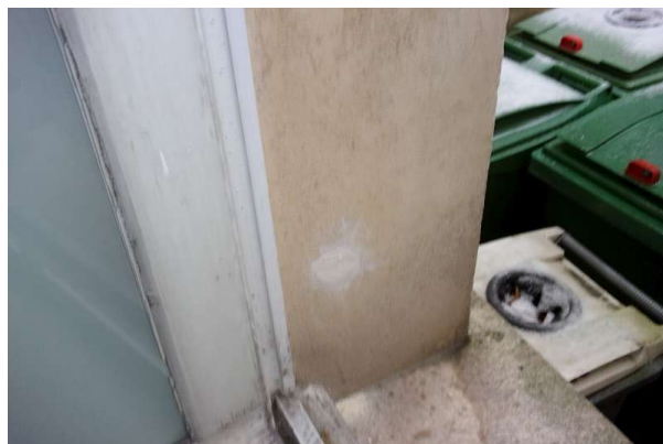
Prélèvement - P294 : R+0 / H11 - Enduit taloché- (Absence d'amiante)
