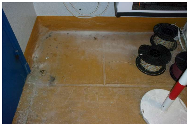
Prélèvement - P396 : R-1 / S17 - Enduit de ragréage- (Absence d'amiante)
