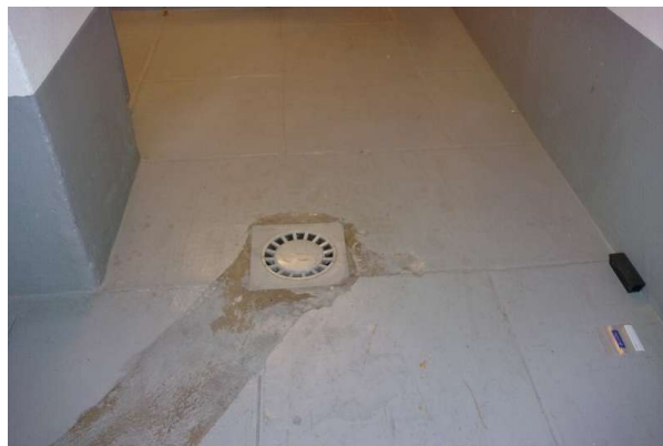
Prélèvement - P406 : R-1 / S30 - Enduit de ragréage- (Absence d'amiante)
