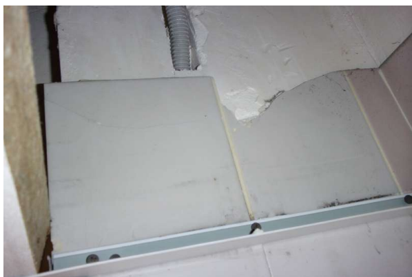
Prélèvement - P085 : R+0 / G30 - Colle de faïence- (Absence d'amiante)
