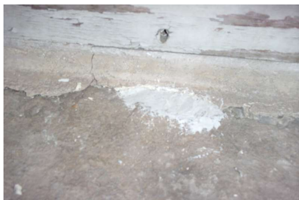
Prélèvement - P108 : R+1 / D111 - Rebouchage- (Absence d'amiante)
