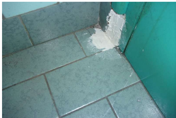
Prélèvement - P140 : R+1 / D139 - Colle de carrelage- (Absence d'amiante)
