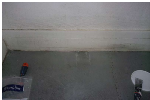
Prélèvement - P360 : R+0 / D16 - Ragréage- (Absence d'amiante)
