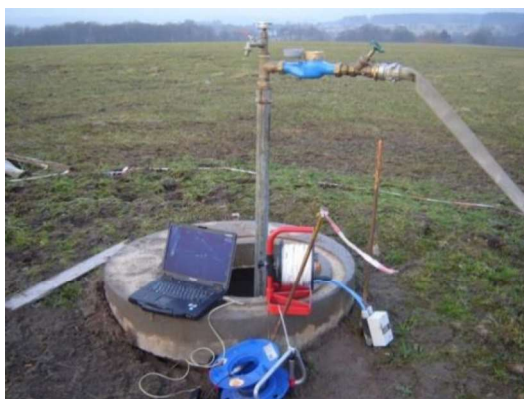
(38) Essai de pompage dans un forage de reconnaissance
