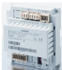
Module d'extension AVS75 Le kit comprend un module AVS75 avec câble de communication vers le régulateur de chaudière LMS14. Raccorder au maximum 3 modules AVS75 à la même chaudière (module 1 et 2 pour la régulation du chauffage, module 3 pour "OK/signal d'alarme" si en combinaison avec le raccordement d'une vanne gaz principale extérieure).
