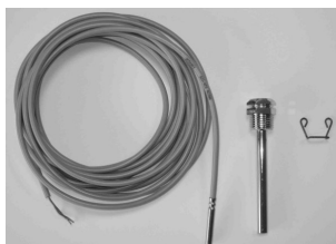
Sonde QAZ36 et douille plongeuse Le kit comprend une sonde QAZ36 avec 6m de câble et une douille plongeuse pour ECS, circuit ou bouteille de découplage.
