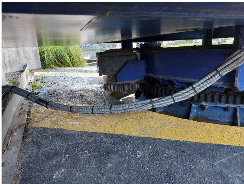
Figure 7 Motoréducteur électrique pour rotation du pont
