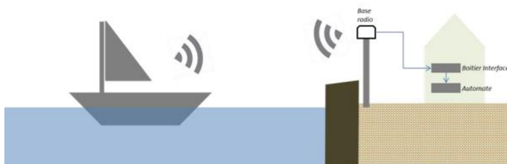
Figure 21 - Schéma de détection des bateaux par télécommande
