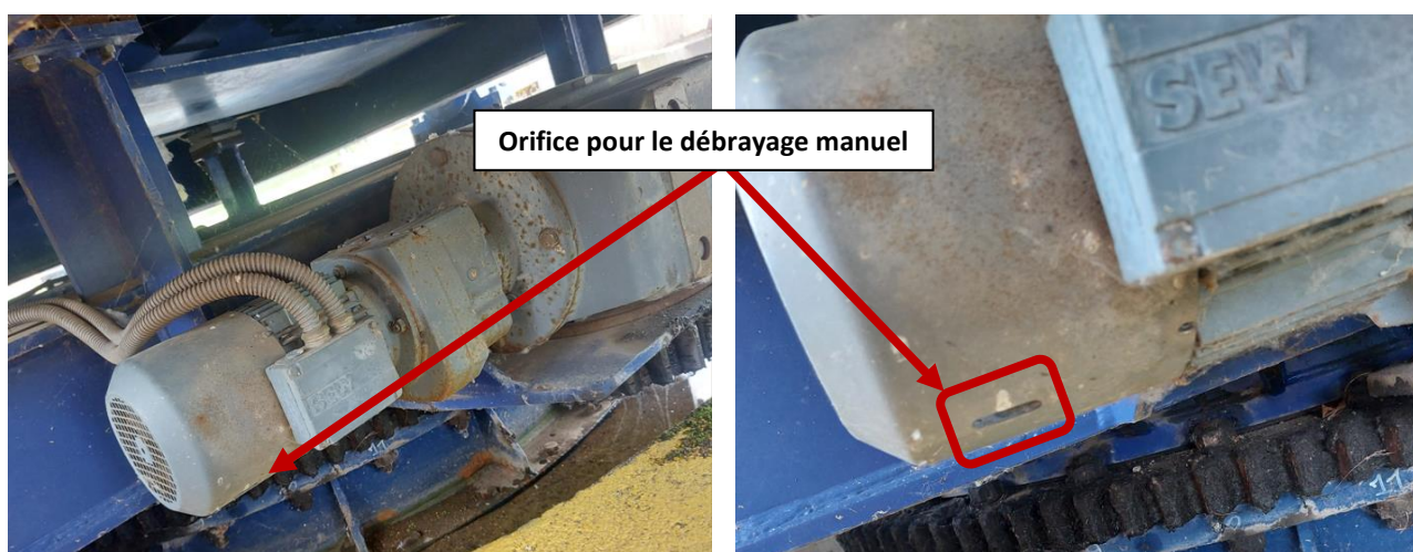
Figure 20 – Emplacement des orifices pour le débrayage manuel
