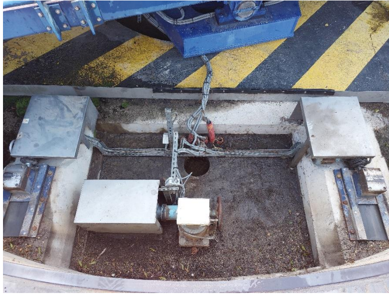
Figure 6 Vérins électriques pour appuis escamotables de part et d'autre du vérin central
