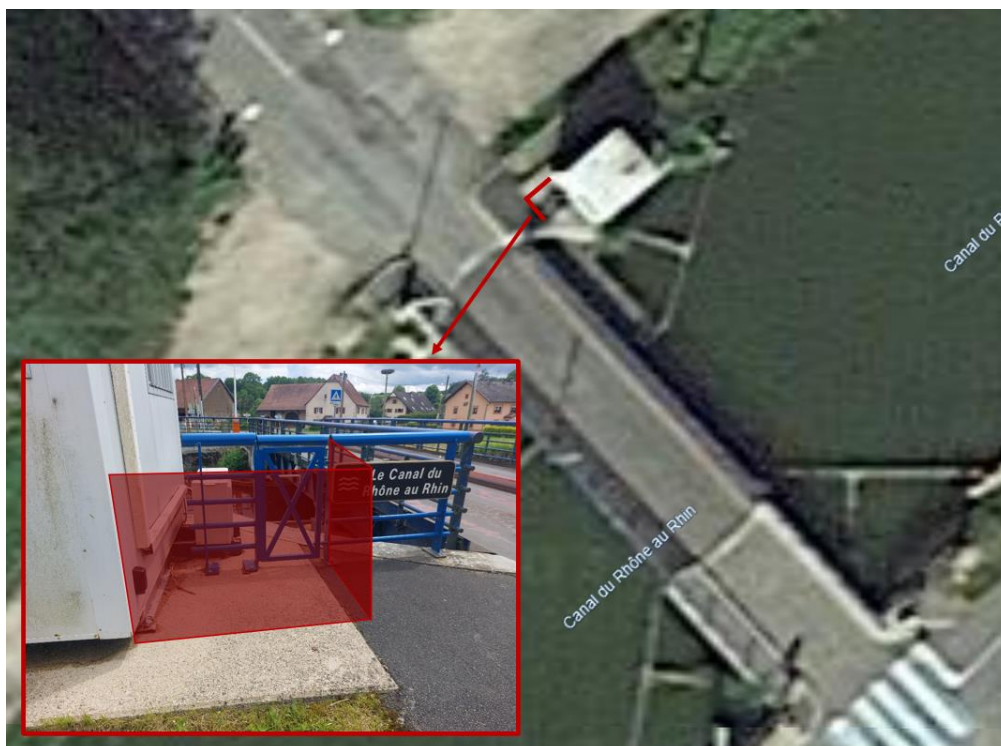
Figure 18 – Mise en œuvre projetée des garde-corps
