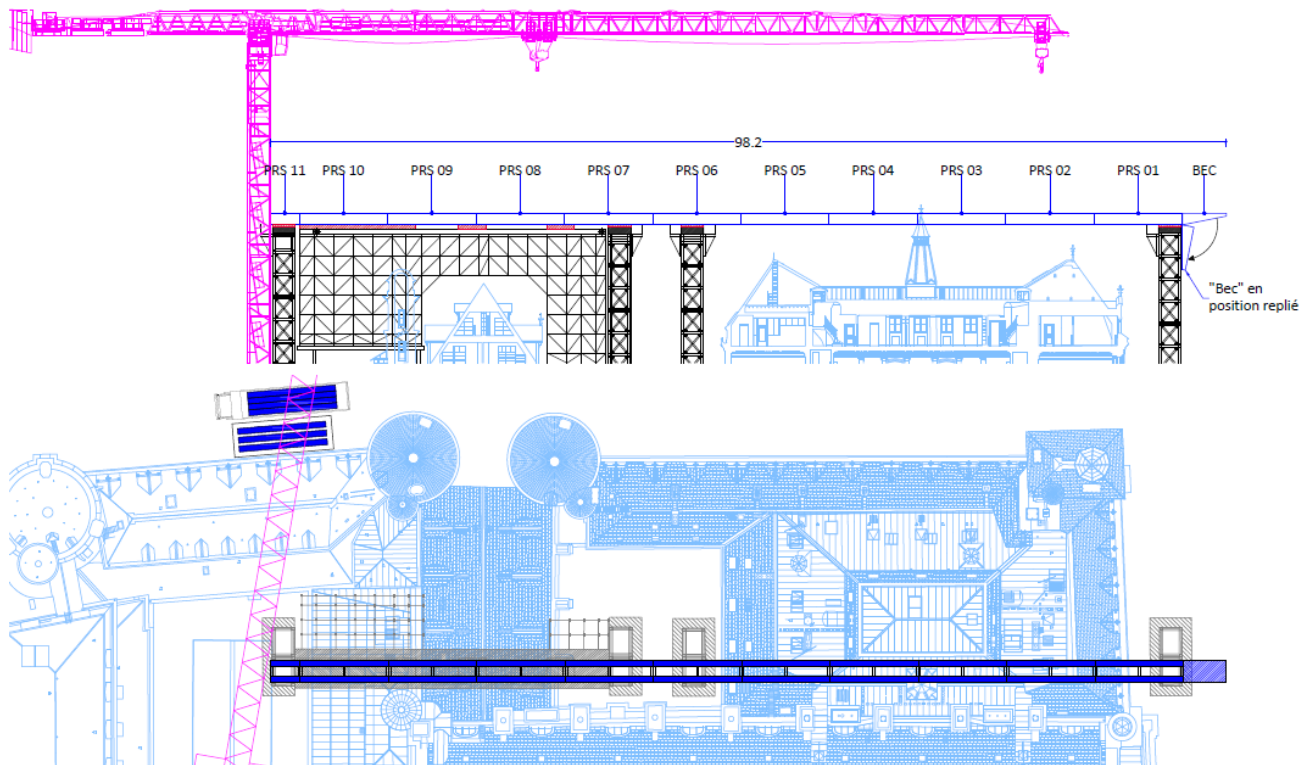
Figure 2 Détail de la poutre support du parapluie
