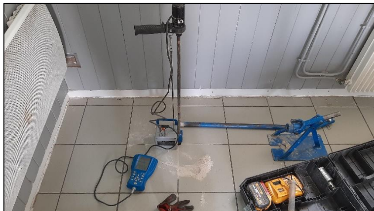
20/03/2023 : Essai au pénétromètre dynamique de type PANDA
