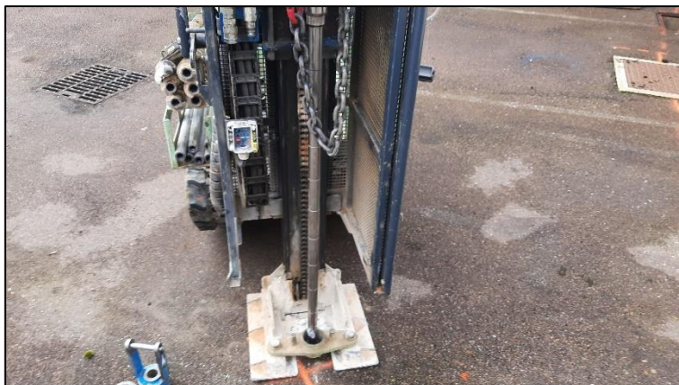
20/03/2023 : Essai au pénétromètre dynamique PD1
