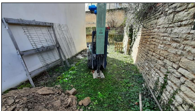
20/03/2023 : Essai au pénétromètre dynamique PD3
