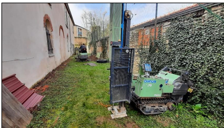
20/03/2023 : Essai au pénétromètre dynamique PD2
