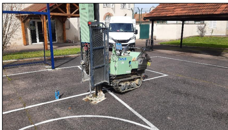
20/03/2023 : Essai au pénétromètre dynamique PD5
