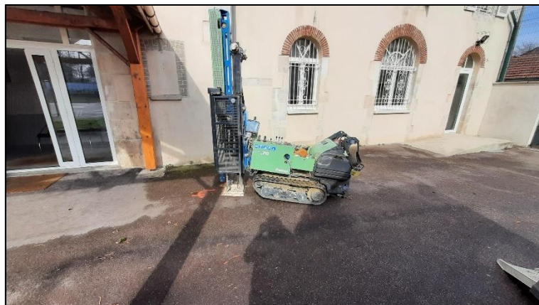
20/03/2023 : Essai au pénétromètre dynamique PD4
