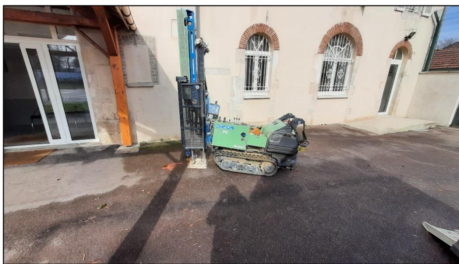
20/03/2023 : Essai au pénétromètre dynamique de type B
