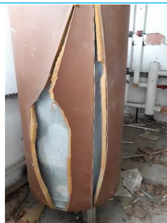
Matériaux : ZPSO-039 Prélèvement : P039 Description : Isolant autour du ballon ECS Localisation : Bâtiment 8 / RDC - Pièce 18 Résultat : Absence d'amiante
