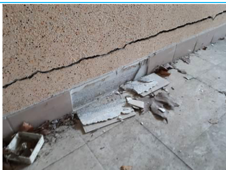
Matériaux : ZPSO-022 Prélèvement : P022 Description : Colle de plinthe Localisation : Bâtiment 8 / RDC - Pièce 13 Résultat : Absence d'amiante
