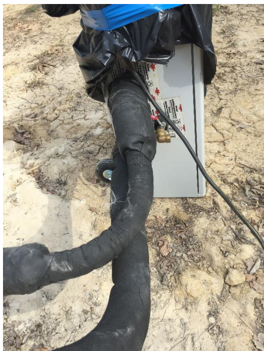
Illustration 3 : Calorifugeage des raccords hydrauliques jusqu'au banc de test
