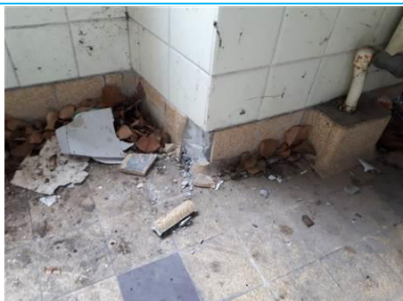
Matériaux : ZPSO-050 Prélèvement : P050 Description : Colle de plinthe Localisation : Bâtiment 8 / R+1 - Pièce 22; Bâtiment 8 / R+1 - Pièce 23 Résultat : Présence d'amiante
