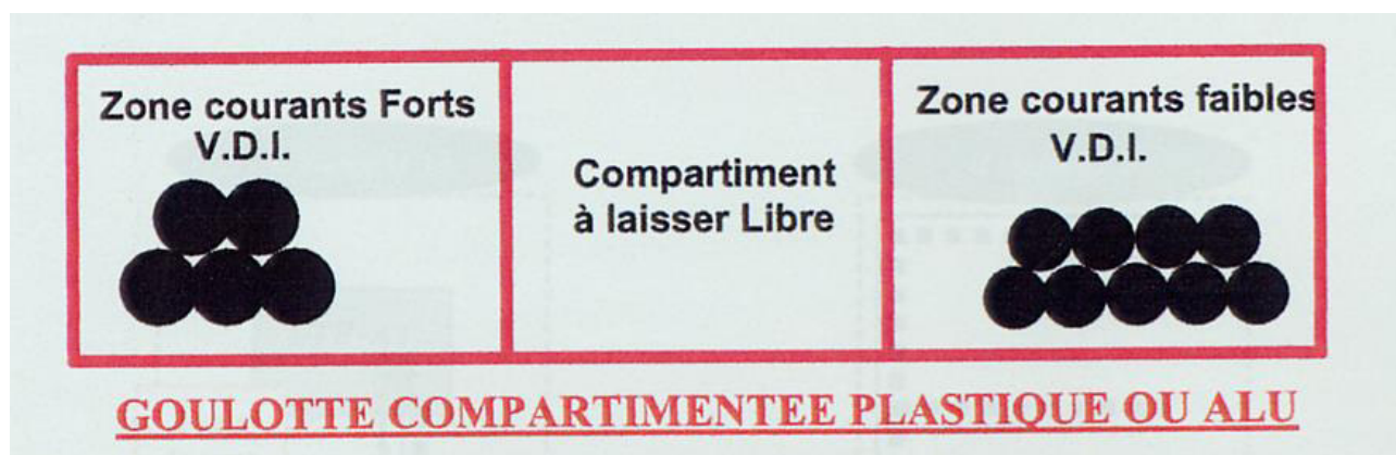
Figure 18 : Goulottes de distribution à trois compartiments
