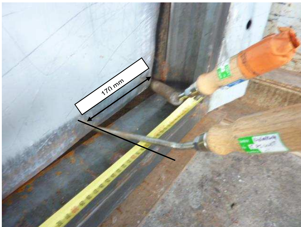
Passage de la pige \varnothing 10 mm au niveau du seuil de la porte
