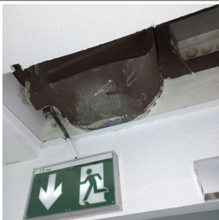
Prélèvement - P025 : RECTORAT - BÂTIMENT PRINCIPAL / NIVEAU R+1 / PC103 - Revêtement- (Absence d'amiante)
