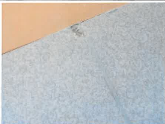
Prélèvement - P001 : R+4 / BUREAU N° 403-B - Ragréage- (Absence d'amiante)
