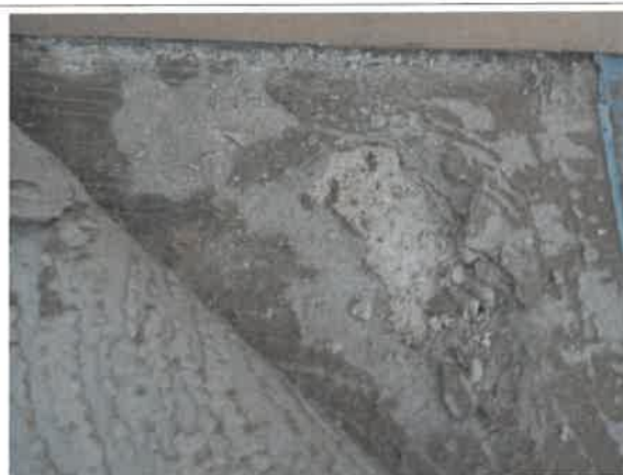
Prélèvement - P006 : R+2 / BUREAU N° 25 A - Ragréage- (Absence d'amiante)
