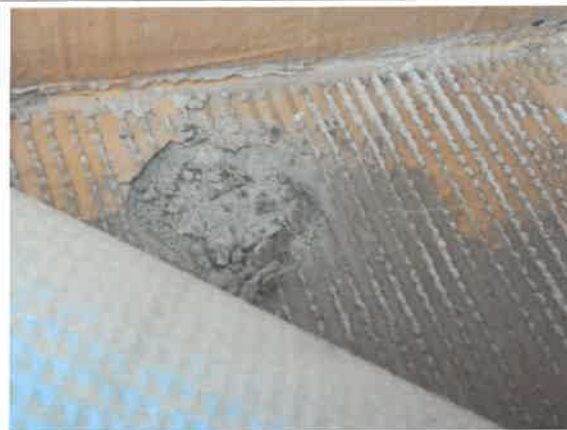
Prélèvement - P002 : R+4 / BUREAU N° 403-B - Ragréage- (Absence d'amiante)
