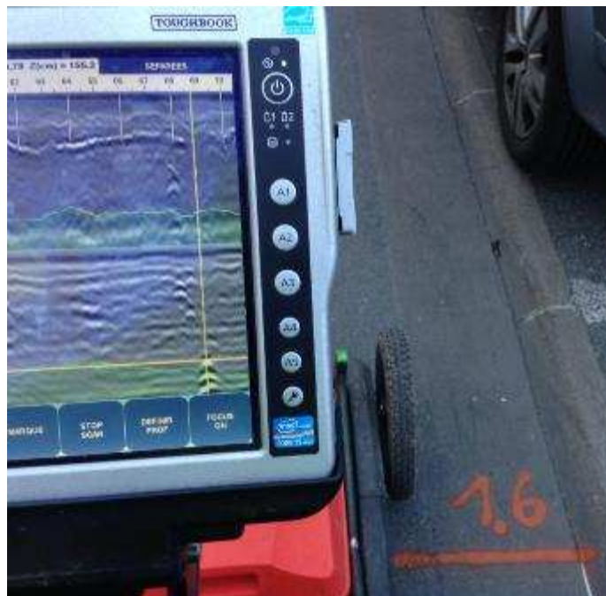
Figure 2 : Exemple de signature radar d'une zone avec de nombreux réseaux
