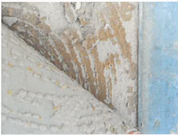
Prélèvement - P007 : R+2 / BUREAU N° 25 A - Ragréage- (Absence d'amiante)
