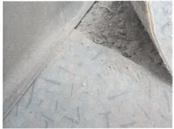
Prélèvement - P010 : R+1 / BUREAU N° 10 C - Ragréage- (Absence d'amiante)
