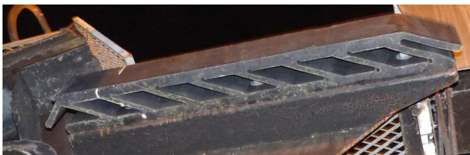
Figure 27 : Exemple de pare-battage pour navire équipant un batardeau flottant
