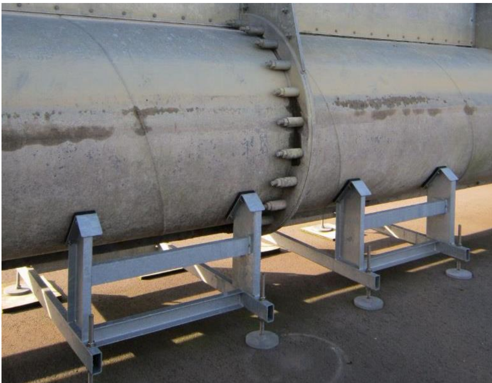
Figure 33 : Exemple de bers-support pour batardeau flottant
