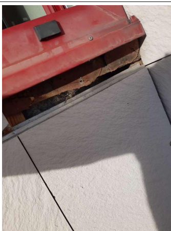
Prélèvement - P009 : CPAM Laon / Façade Sud-Est - Mastic- (Absence d'amiante)
