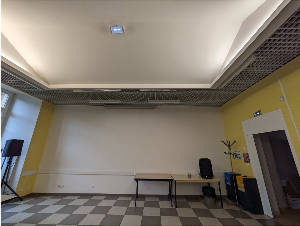
Vue de la salle Pierre Bayle. Le faux-plafond grille périphérique sera déposée et reposée pour la mise en place des canalisations par le lot CVC.
