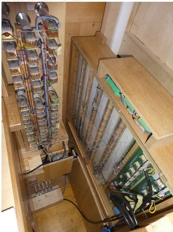
Photo 15 : exemple d'intégration de tableau de cartes de sorties sous coffret à côté du tirage des jeux.
