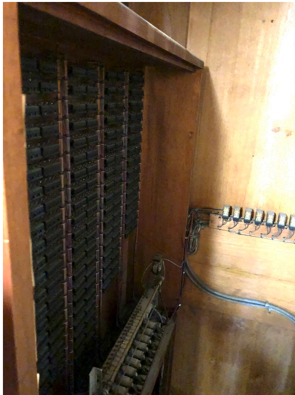
Photo 29 : Armoire électronique du combineur actuel (8 combinaisons)
