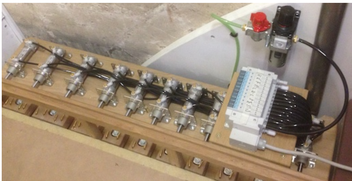
Photo 35 : Exemple de tirage de jeux par vérins pneumatiques avec servovalves de commande. (Orgue de Notre Dame de Paris).
