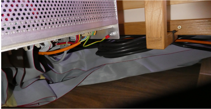
Photo 18 : exemple de nappes de câbles transitant les informations des cartes de sortie au boîtier Master de l'électronique.
