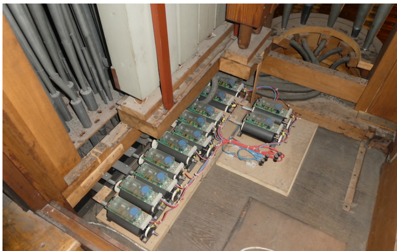
Photo 26 : Groupe des moteurs de jeux du plan sonore de positif
