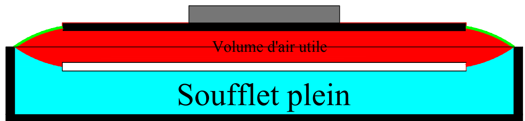
Extrait graphique 4 : Mise en évidence des volumes mort et utile dans un soufflet à table flottante.
