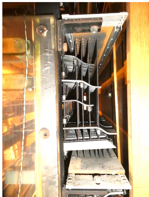
Photo 12 Détail des fourchettes d'accouplement et tirasses : vue en bout et de profil
