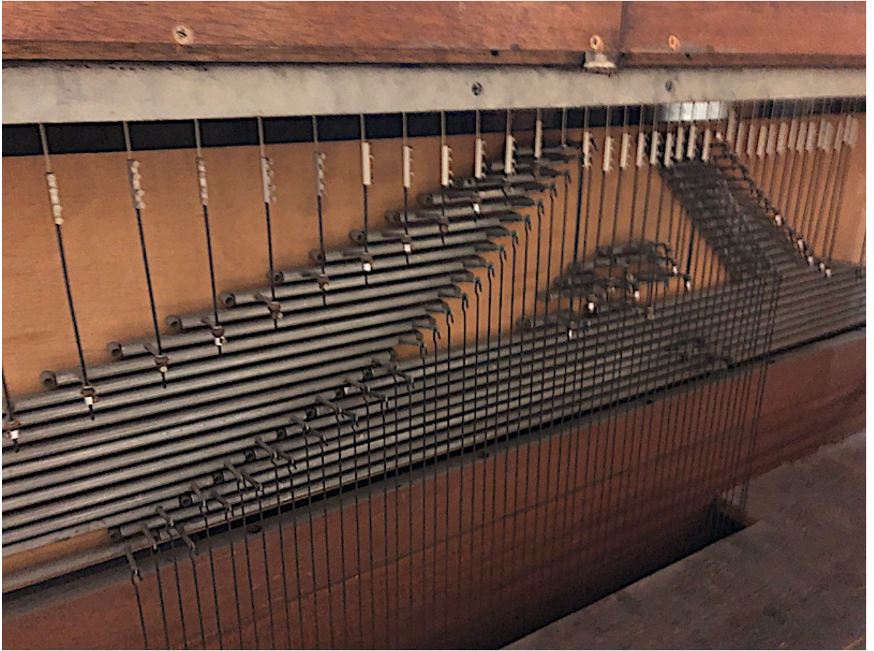
Photo 10 : Mécanique du plan d'Écho : abrégé et liaisons par fils aux sommiers
