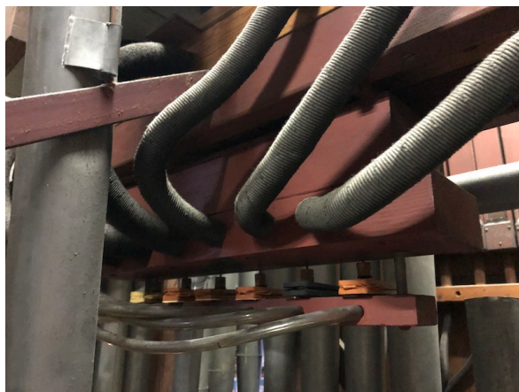
Photo 50 : Moteurs pneumatiques de basses, Bourdon 16 Grand orgue côté Ut
