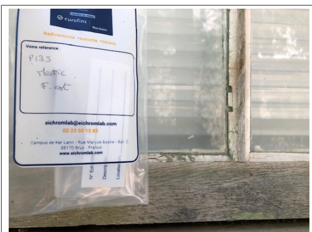
Prélèvement - P135 : BATIMENT ATELIER / Extérieur - Mastic- (Absence d'amiante)
