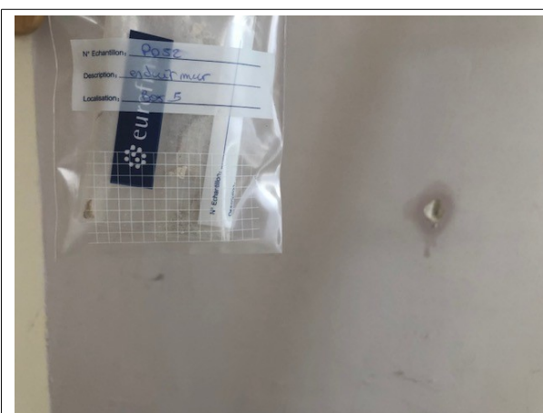
Prélèvement - P052 : BATIMENT ATELIER / Salle de sport / Vestiaires - Enduit- (Absence d'amiante)
