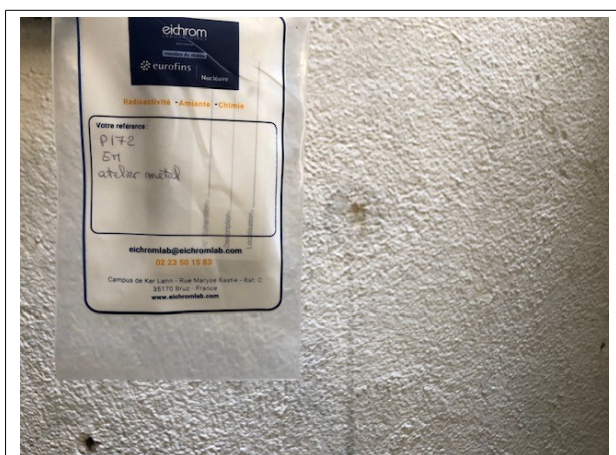
Prélèvement - P172 : BATIMENT ATELIER / Atelier bois 1 / Atelier métal - Enduit- (Absence d'amiante)
