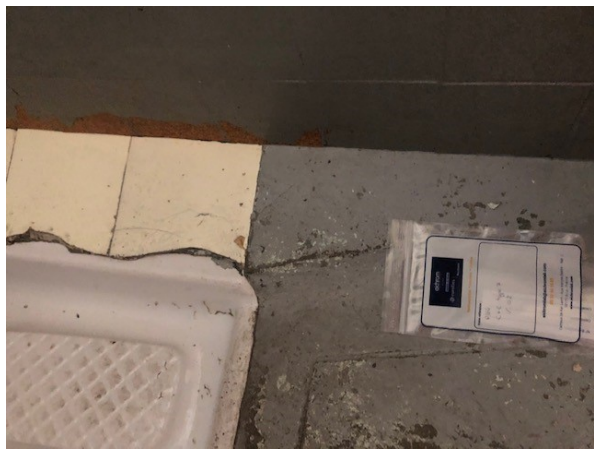
Prélèvement - P164 : BATIMENT ATELIER / Atelier bois 1 / Vestiaire 02 - Colle de carrelage- (Absence d'amiante)
