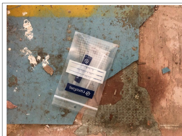
Prélèvement - P088 : BATIMENT ATELIER / Atelier bois 2 - Colle- (Absence d'amiante)
