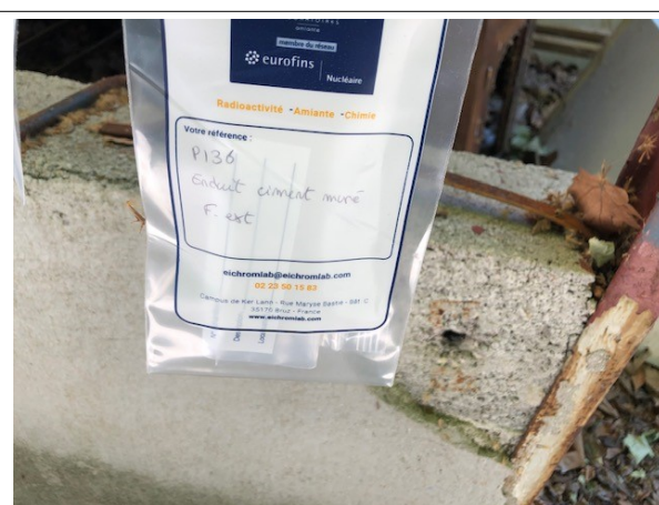
Prélèvement - P136 : BATIMENT ATELIER / Extérieur - Enduit- (Absence d'amiante)
