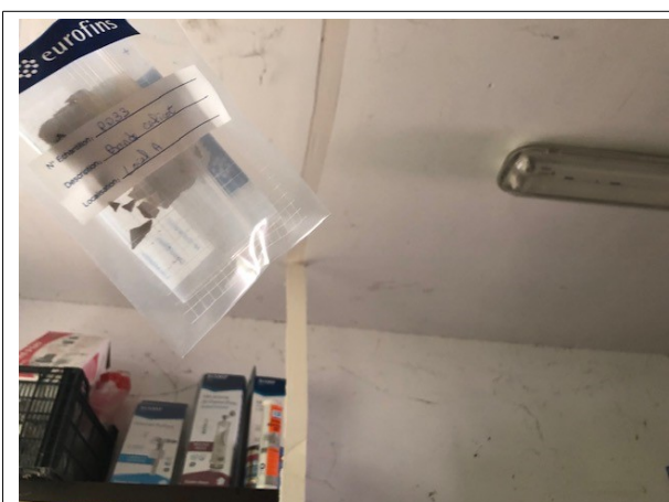
Prélèvement - P033 : BATIMENT ATELIER / GARAGE UPCA / Local A - Bande calicot- (Absence d'amiante)
