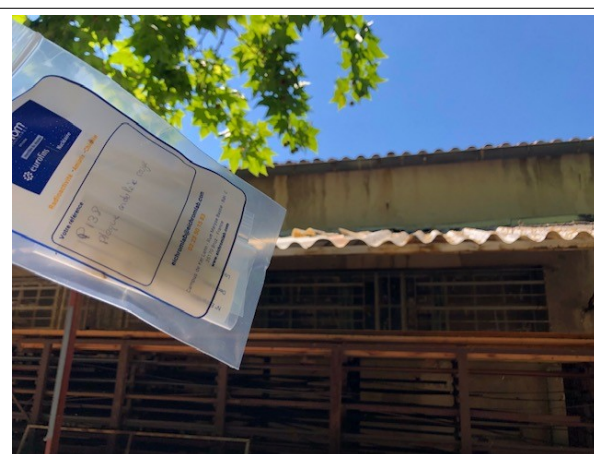
Prélèvement - P138 : BATIMENT ATELIER / Extérieur - Plaque ondulée- (Absence d'amiante)
