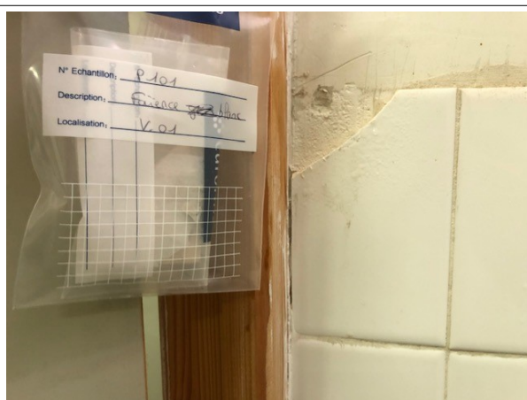
Prélèvement - P101 : BATIMENT ATELIER / Atelier bois 2 / Vestiaire 01 - Colle de faïence- (Absence d'amiante)
