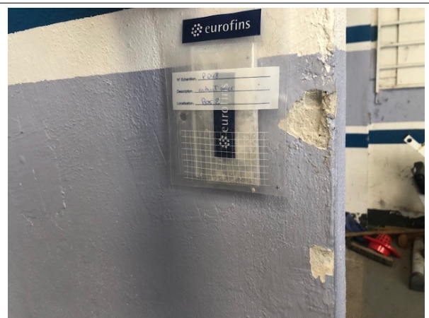
Prélèvement - P048 : BATIMENT ATELIER / Salle de sport - Enduit- (Absence d'amiante)
