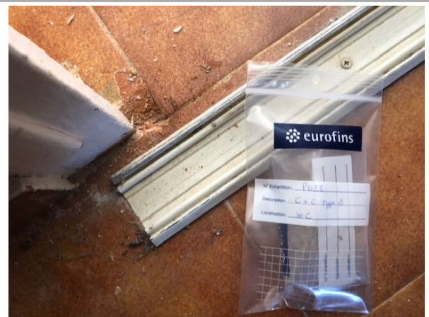
Prélèvement - P022 : BATIMENT ATELIER / GARAGE UPCA / WC - Colle de carrelage- (Présence d'amiante)
