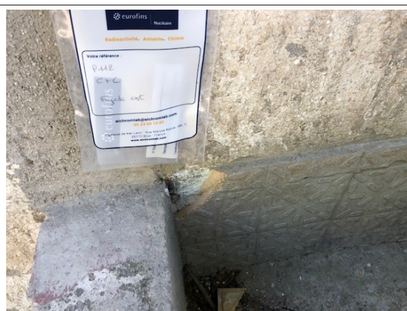
Prélèvement - P112 : BATIMENT ATELIER / Extérieur - Colle de faïence- (Absence d'amiante)
