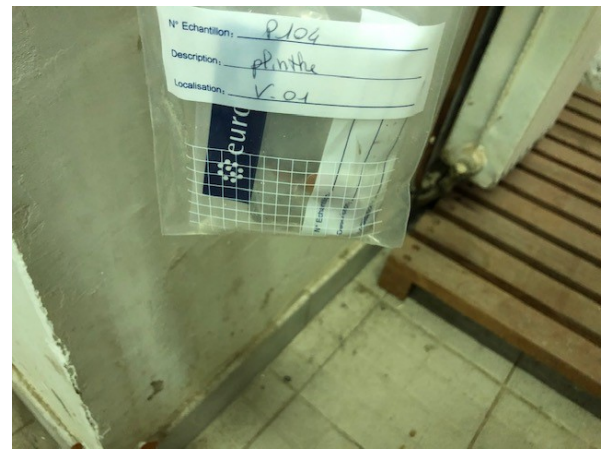
Prélèvement - P104 : BATIMENT ATELIER / Atelier bois 2 / Vestiaire 01 - Colle de plinthe- (Absence d'amiante)
