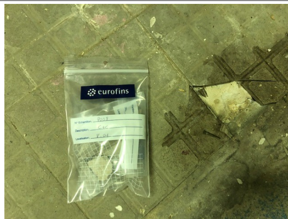
Prélèvement - P098 : BATIMENT ATELIER / Atelier bois 2 / Vestiaire 01 - Colle de carrelage- (Absence d'amiante)
