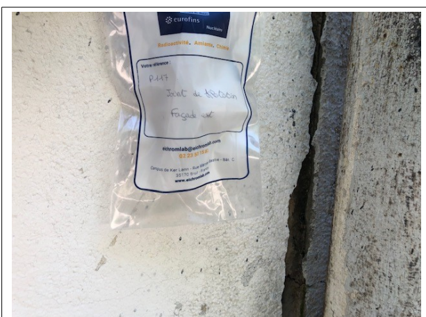
Prélèvement - P117 : BATIMENT ATELIER / Extérieur - Joint de dilatation- (Absence d'amiante)
