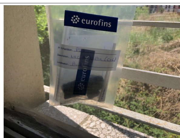
Prélèvement - P016 : BATIMENT ATELIER / GARAGE UPCA / Archives - Colle de carrelage- (Absence d'amiante)
