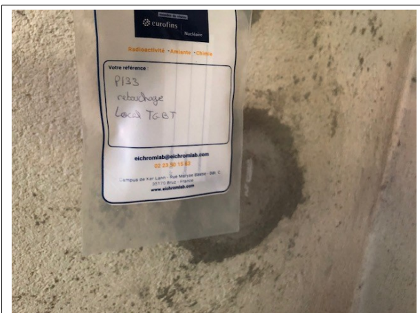
Prélèvement - P133 : BATIMENT ATELIER / Local TGBT - Enduit- (Absence d'amiante)
