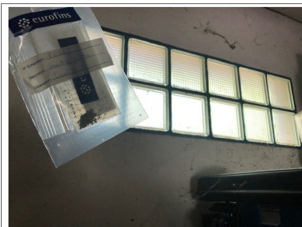
Prélèvement - P031 : BATIMENT ATELIER / GARAGE UPCA / Local A - Joint- (Absence d'amiante)
