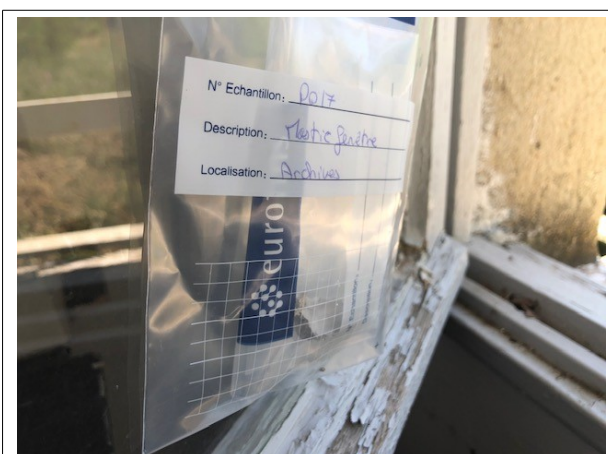
Prélèvement - P017 : BATIMENT ATELIER / GARAGE UPCA / Archives - Mastic- (Absence d'amiante)
