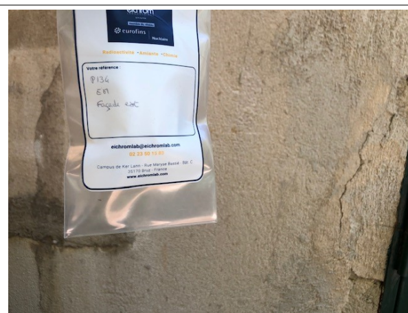
Prélèvement - P134 : BATIMENT ATELIER / Extérieur - Enduit- (Absence d'amiante)
