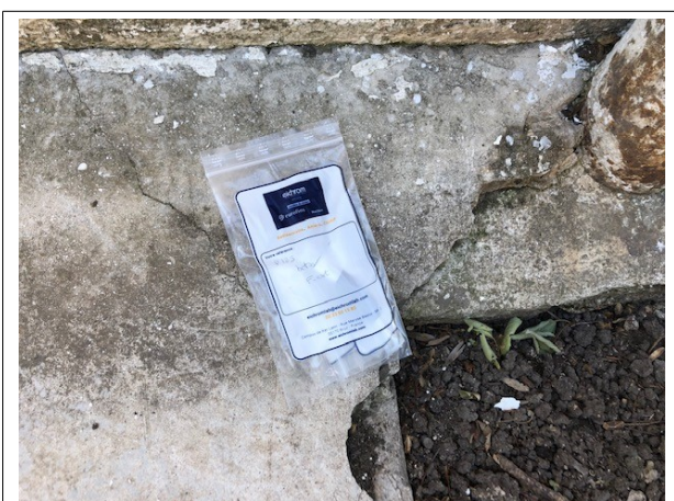
Prélèvement - P129 : BATIMENT ATELIER / Extérieur - Sol coulé- (Absence d'amiante)
