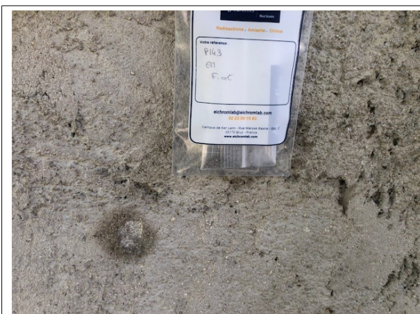
Prélèvement - P143 : BATIMENT ATELIER / Extérieur - Enduit- (Absence d'amiante)
