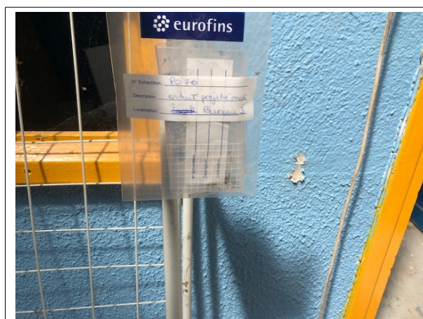
Prélèvement - P070 : BATIMENT ATELIER / Association - Enduit projeté- (Absence d'amiante)
