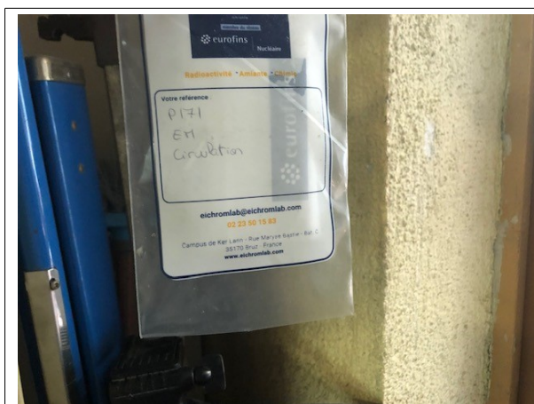
Prélèvement - P171 : BATIMENT ATELIER / Atelier bois 1 / Circulation - Enduit- (Absence d'amiante)
