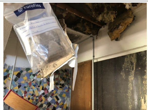
Prélèvement - P030 : BATIMENT ATELIER / GARAGE UPCA / SAS - Faux plafond- (Absence d'amiante)
