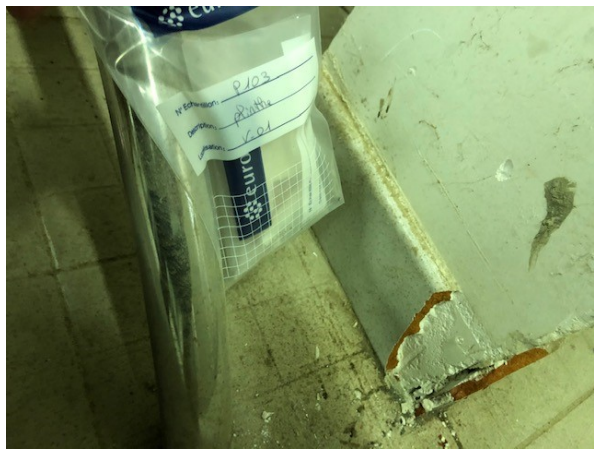
Prélèvement - P103 : BATIMENT ATELIER / Atelier bois 2 / Vestiaire 01 - Colle de plinthe- (Absence d'amiante)
