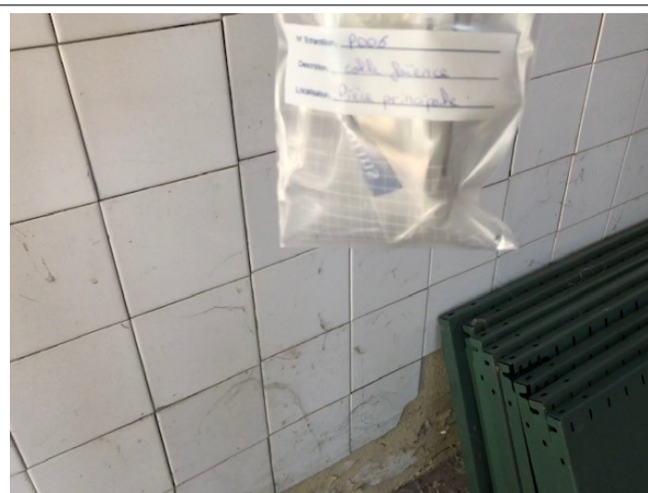
Prélèvement - P006 : BATIMENT ATELIER / GARAGE UPCA - Colle de faïence- (Absence d'amiante)
