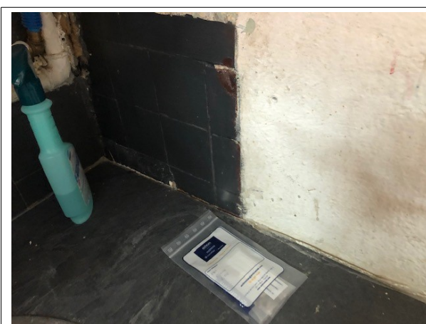
Prélèvement - P161 : BATIMENT ATELIER / Atelier bois 1 / Vestiaire 02 - Colle de faïence- (Absence d'amiante)
