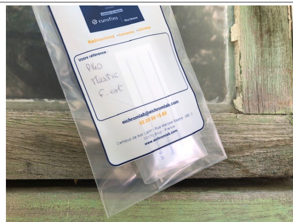
Prélèvement - P140 : BATIMENT ATELIER / Extérieur - Mastic- (Absence d'amiante)
