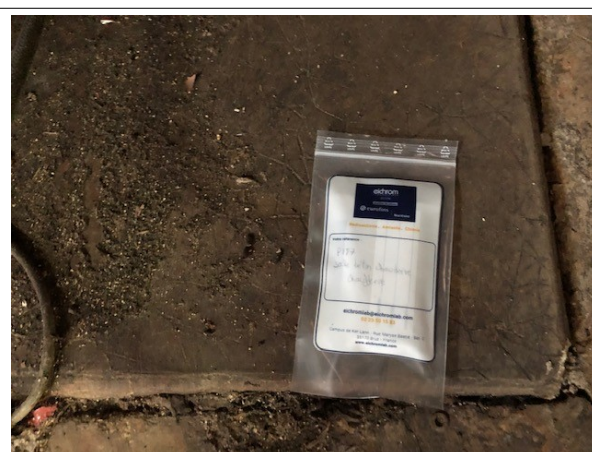
Prélèvement - P187 : BATIMENT ATELIER / Chaufferie - Sol coulé- (Absence d'amiante)
