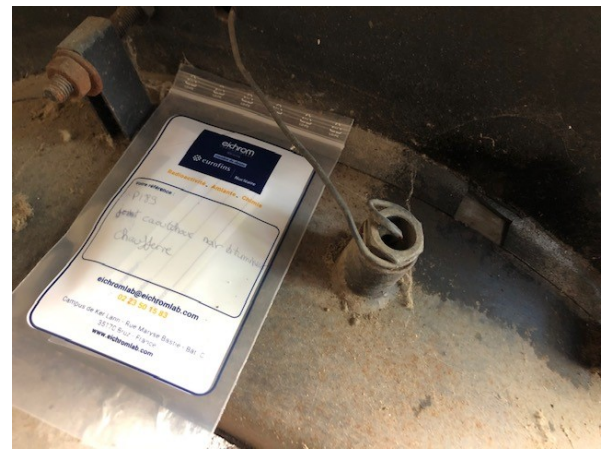
Prélèvement - P189 : BATIMENT ATELIER / Chauffage - Joint- (Absence d'amiante)
