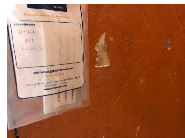
Prélèvement - P177 : BATIMENT ATELIER / Atelier bois 1 / Local 3 - Enduit- (Absence d'amiante)
