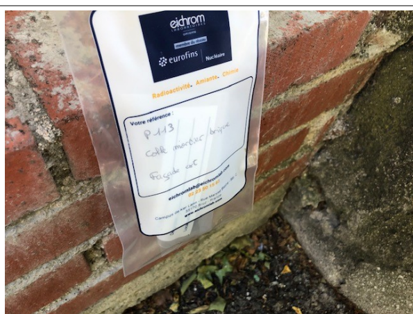
Prélèvement - P113 : BATIMENT ATELIER / Extérieur - Colle de carrelage- (Absence d'amiante)
