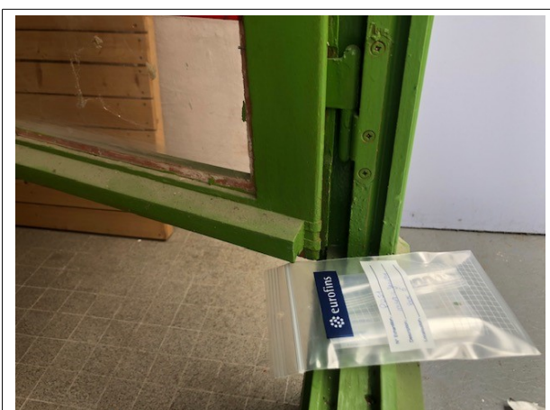
Prélèvement - P051 : BATIMENT ATELIER / Salle de sport / Vestiaires - Mastic- (Absence d'amiante)
