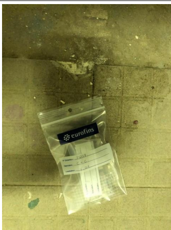
Prélèvement - P097 : BATIMENT ATELIER / Atelier bois 2 / Vestiaire 01 - Colle de carrelage- (Absence d'amiante)
