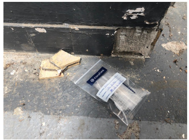
Prélèvement - P044 : BATIMENT ATELIER / Salle de sport - Colle de plinthe- (Absence d'amiante)
