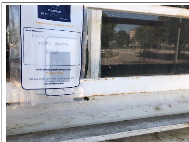
Prélèvement - P120 : BATIMENT ATELIER / Extérieur - Mastic- (Absence d'amiante)
