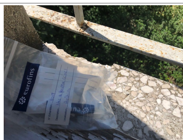
Prélèvement - P018 : BATIMENT ATELIER / GARAGE UPCA / Archives - Colle de carrelage- (Absence d'amiante)
