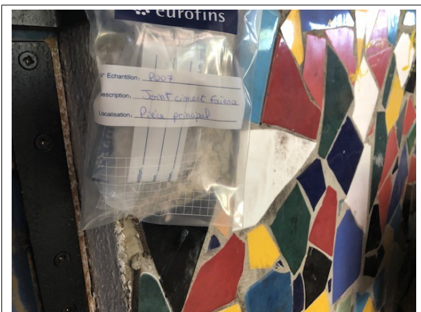
Prélèvement - P007 : BATIMENT ATELIER / GARAGE UPCA - Joint de faïence- (Absence d'amiante)
