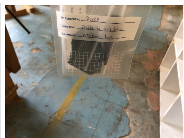
Prélèvement - P087 : BATIMENT ATELIER / Atelier bois 2 - Dalle de sol- (Absence d'amiante)
