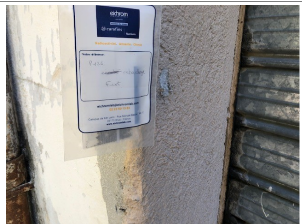
Prélèvement - P124 : BATIMENT ATELIER / Extérieur - Enduit- (Absence d'amiante)
