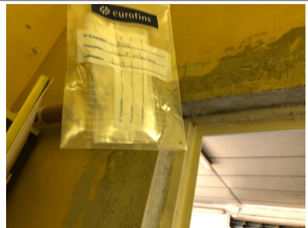
Prélèvement - P106 : BATIMENT ATELIER / Atelier bois 2 / Local matériel 1 - Enduit- (Absence d'amiante)
