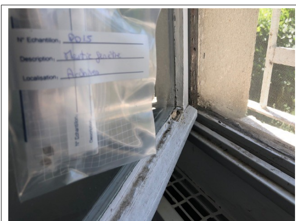
Prélèvement - P015 : BATIMENT ATELIER / GARAGE UPCA / Archives - Mastic- (Absence d'amiante)
