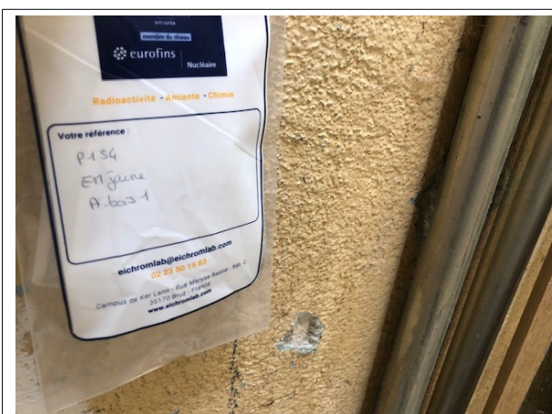
Prélèvement - P154 : BATIMENT ATELIER / Atelier bois 1 - Enduit- (Absence d'amiante)
