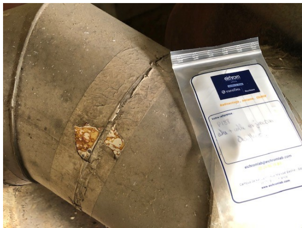
Prélèvement - P188 : BATIMENT ATELIER / Chauffage - Colle- (Absence d'amiante)
