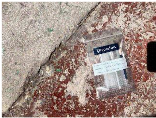
Prélèvement - P061 : BATIMENT ATELIER / Association - Sol coulé- (Absence d'amiante)
