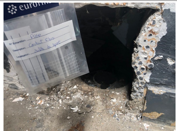
Prélèvement - P060 : BATIMENT ATELIER / Salle de sport - Conduit- (Absence d'amiante)
