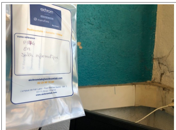
Prélèvement - P174 : BATIMENT ATELIER / Atelier bois 1 / Salle informatique - Enduit- (Absence d'amiante)
