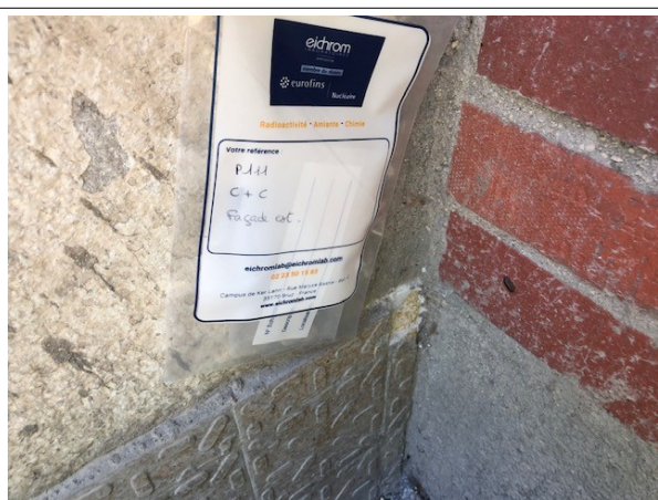
Prélèvement - P111 : BATIMENT ATELIER / Extérieur - Colle de faïence- (Absence d'amiante)
