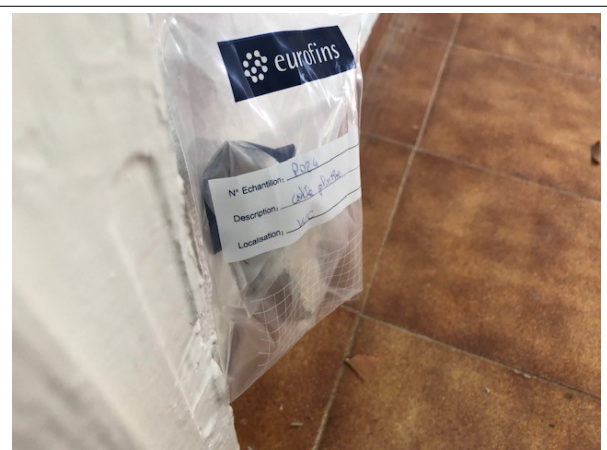
Prélèvement - P024 : BATIMENT ATELIER / GARAGE UPCA / WC - Colle de plinthe- (Présence d'amiante)
