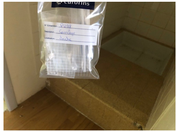
Prélèvement - P038 : BATIMENT ATELIER / GARAGE UPCA / Douche - Colle de carrelage- (Absence d'amiante)
