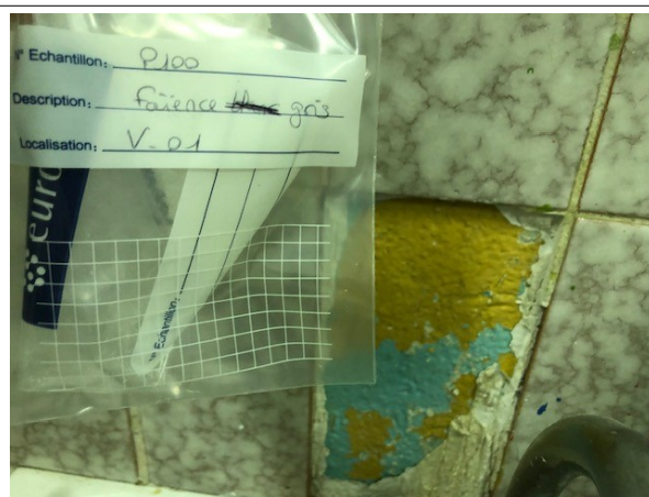
Prélèvement - P100 : BATIMENT ATELIER / Atelier bois 2 / Vestiaire 01 - Colle de faïence- (Absence d'amiante)
