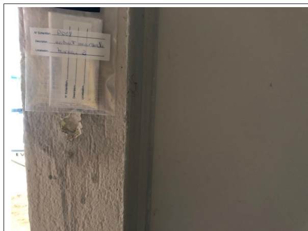
Prélèvement - P068 : BATIMENT ATELIER / Association / Bureau 2 - Enduit- (Absence d'amiante)
