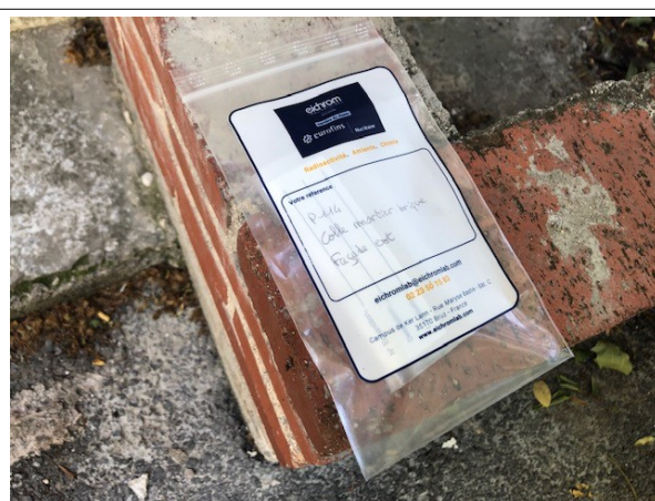
Prélèvement - P114 : BATIMENT ATELIER / Extérieur - Colle de carrelage- (Absence d'amiante)
