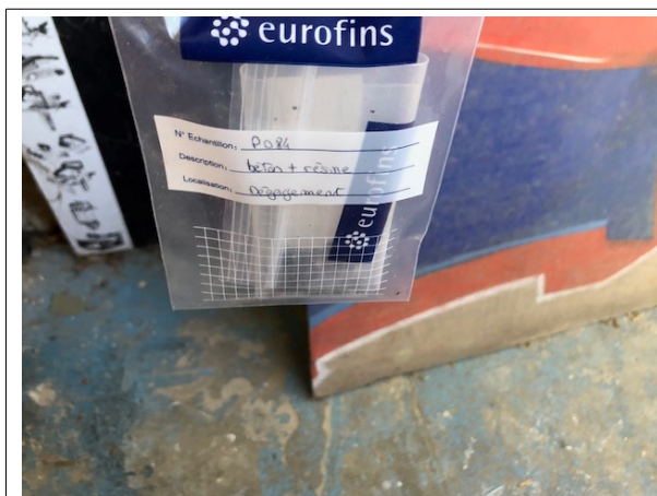
Prélèvement - P084 : BATIMENT ATELIER / Atelier bois 2 / Dégagement entrée - Sol coulé- (Absence d'amiante)
