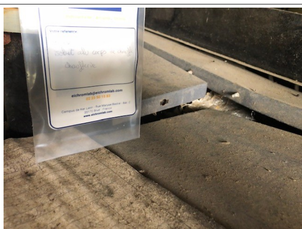
Prélèvement - P186 : BATIMENT ATELIER / Chaufferie - Isolant- (Absence d'amiante)
