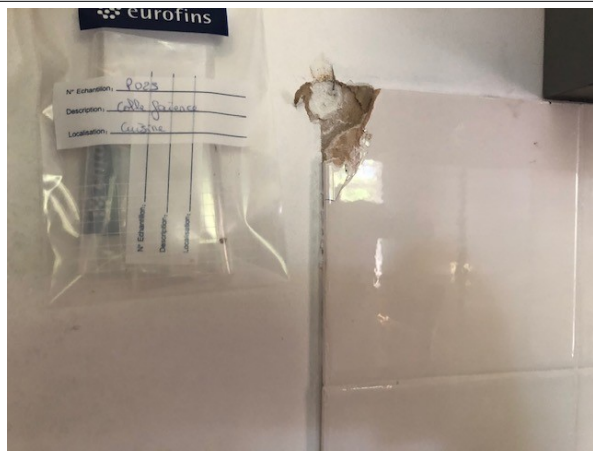
Prélèvement - P025 : BATIMENT ATELIER / GARAGE UPCA / Cuisine - Colle de faïence- (Absence d'amiante)
