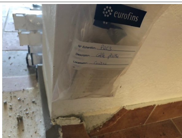
Prélèvement - P023 : BATIMENT ATELIER / GARAGE UPCA / Cuisine - Colle de plinthe- (Présence d'amiante)
