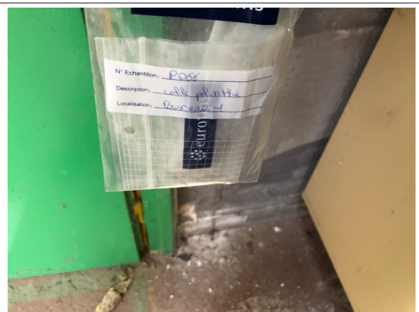
Prélèvement - P066 : BATIMENT ATELIER / Association / Bureau 1 - Colle de plinthe- (Absence d'amiante)
