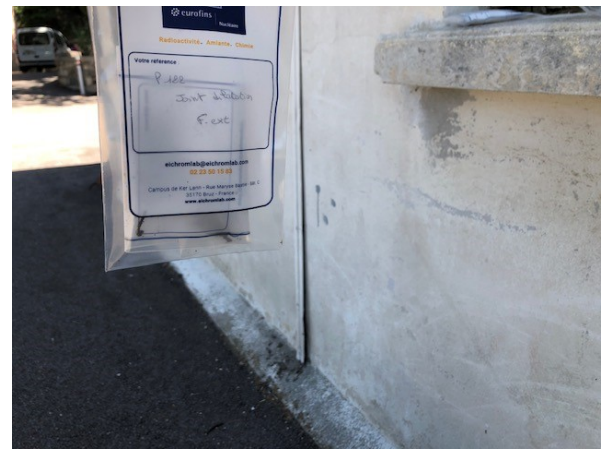
Prélèvement - P122 : BATIMENT ATELIER / Extérieur - Joint de dilatation- (Absence d'amiante)
