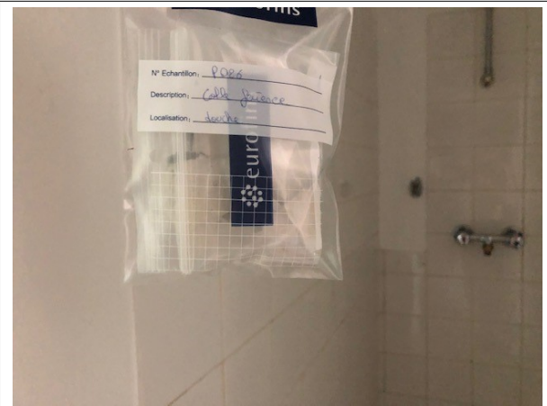
Prélèvement - P026 : BATIMENT ATELIER / GARAGE UPCA / Douche - Colle de faïence- (Absence d'amiante)
