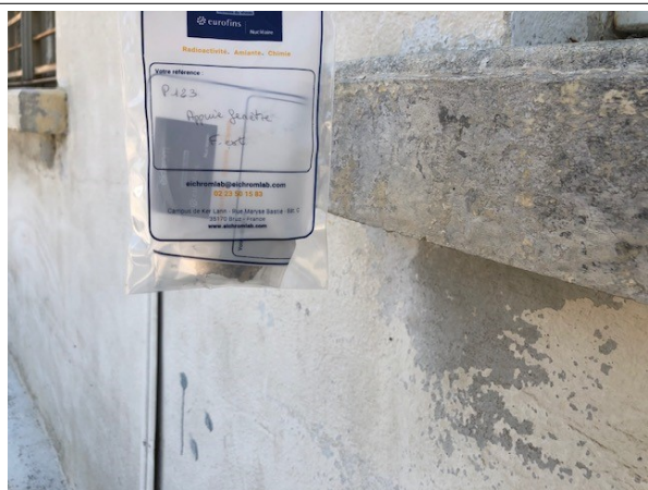
Prélèvement - P123 : BATIMENT ATELIER / Extérieur - Colle de carrelage- (Absence d'amiante)
