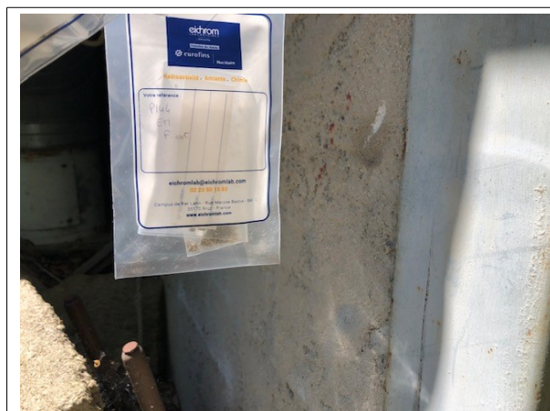
Prélèvement - P144 : BATIMENT ATELIER / Extérieur - Enduit- (Absence d'amiante)
