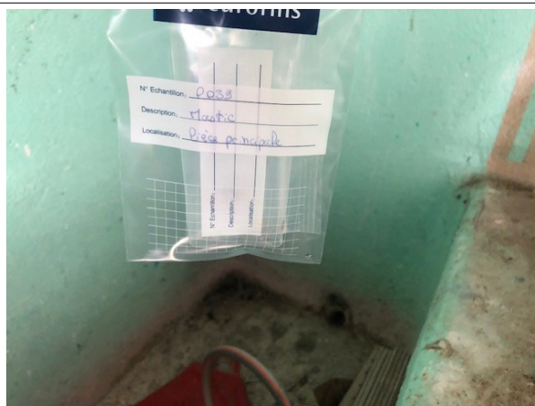
Prélèvement - P039 : BATIMENT ATELIER / GARAGE UPCA - Mastic- (Présence d'amiante)
