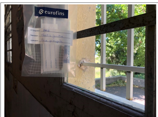
Prélèvement - P009 : BATIMENT ATELIER / GARAGE UPCA - Mastic- (Absence d'amiante)
