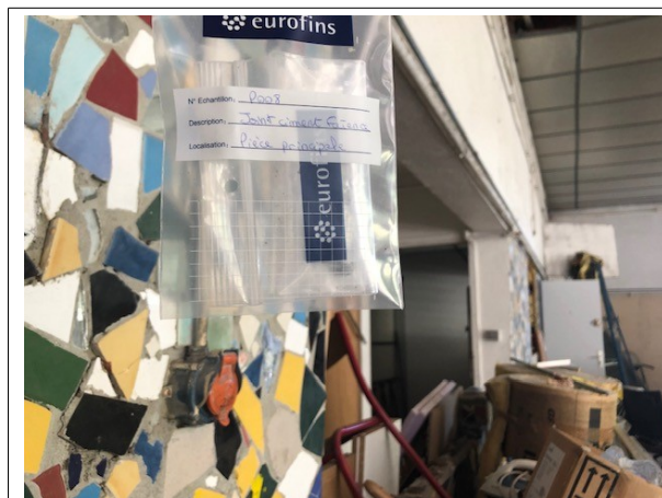
Prélèvement - P008 : BATIMENT ATELIER / GARAGE UPCA - Joint de faïence- (Absence d'amiante)
