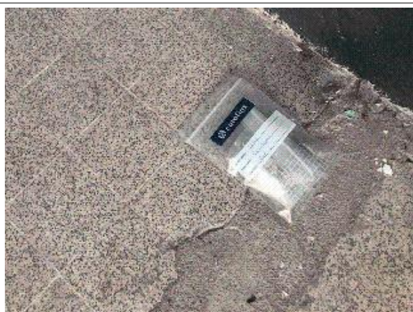
Prélèvement - P041 : BATIMENT ATELIER / Salle de sport - Colle de carrelage- (Absence d'amiante)
