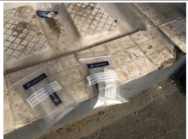
Prélèvement - P046 : BATIMENT ATELIER / Salle de sport / Circulation sanitaires - Colle de carrelage- (Absence d'amiante)
