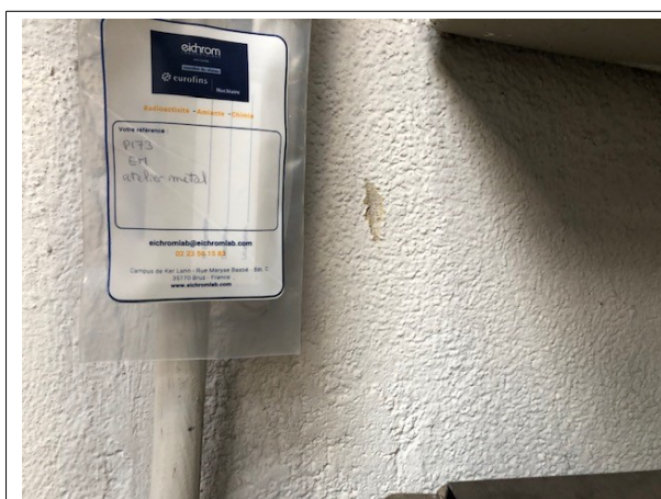
Prélèvement - P173 : BATIMENT ATELIER / Atelier bois 1 / Atelier métal - Enduit- (Absence d'amiante)
