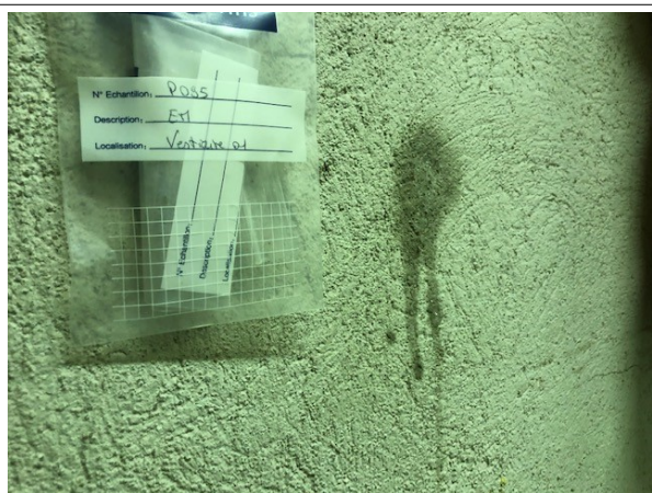
Prélèvement - P095 : BATIMENT ATELIER / Atelier bois 2 / Vestiaire 01 - Enduit- (Absence d'amiante)
