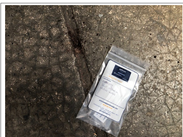
Prélèvement - P178 : BATIMENT ATELIER / Atelier bois 1 / Atelier métal - Joint de dilatation- (Absence d'amiante)
