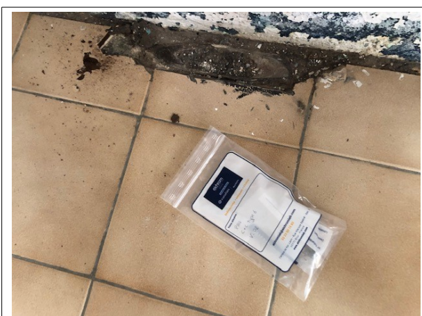
Prélèvement - P160 : BATIMENT ATELIER / Atelier bois 1 / Vestiaire 02 - Colle de carrelage- (Absence d'amiante)
