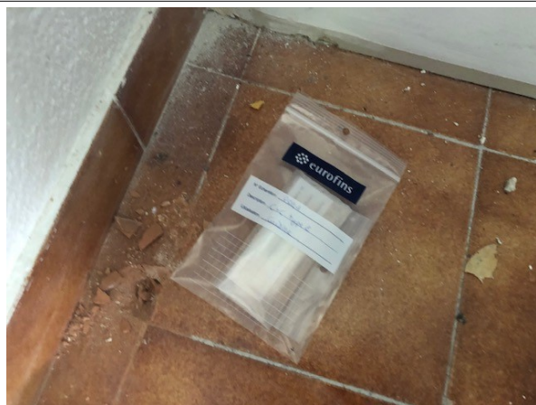
Prélèvement - P021 : BATIMENT ATELIER / GARAGE UPCA / Cuisine - Colle de carrelage- (Présence d'amiante)
