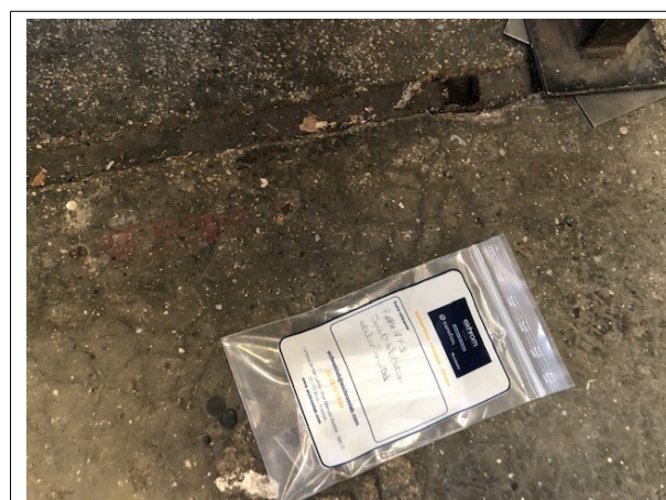
Prélèvement - P179 : BATIMENT ATELIER / Atelier bois 1 / Atelier métal - Joint de dilatation- (Absence d'amiante)
