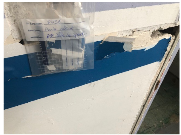
Prélèvement - P056 : BATIMENT ATELIER / Salle de sport - Bande calicot- (Absence d'amiante)
