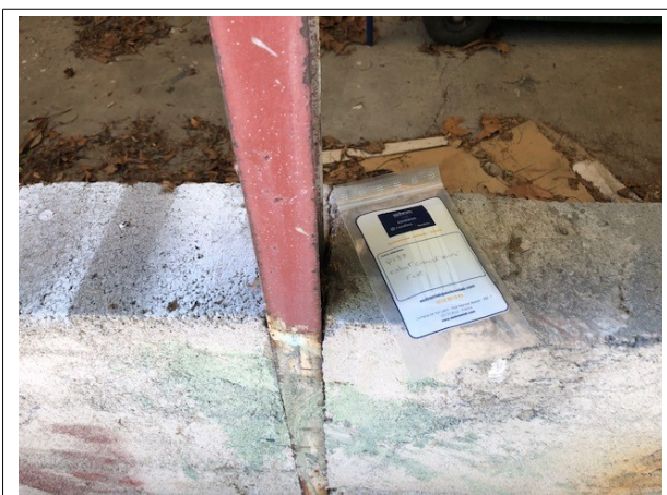
Prélèvement - P137 : BATIMENT ATELIER / Extérieur - Enduit- (Absence d'amiante)
