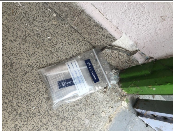
Prélèvement - P045 : BATIMENT ATELIER / Salle de sport / Vestiaires - Colle de plinthe- (Présence d'amiante)
