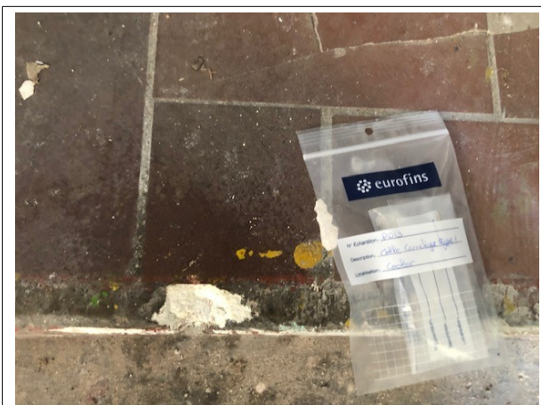
Prélèvement - P013 : BATIMENT ATELIER / GARAGE UPCA / Couloir - Colle de carrelage- (Présence d'amiante)
