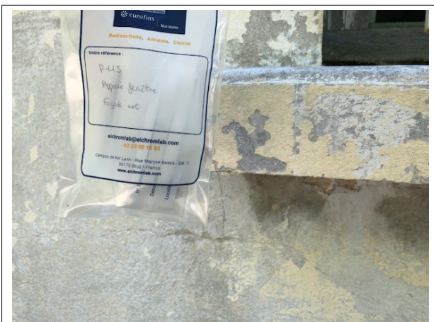
Prélèvement - P115 : BATIMENT ATELIER / Extérieur - Colle de carrelage- (Absence d'amiante)
