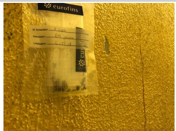
Prélèvement - P094 : BATIMENT ATELIER / Atelier bois 2 / Local matériel 1 - Enduit- (Absence d'amiante)
