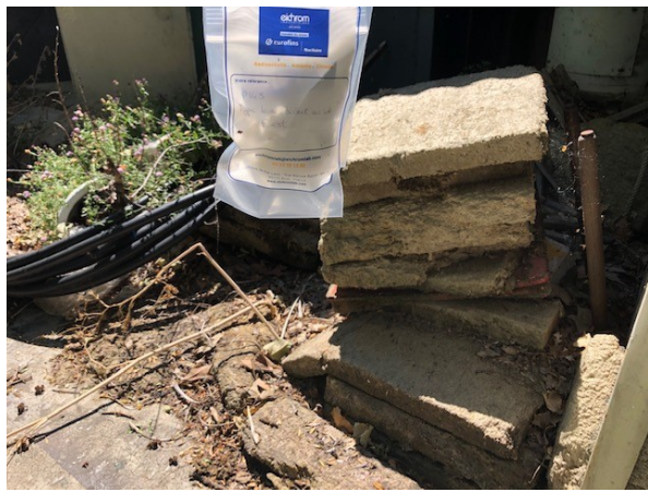
Prélèvement - P145 : BATIMENT ATELIER / Extérieur - Isolant- (Présence d'amiante)
