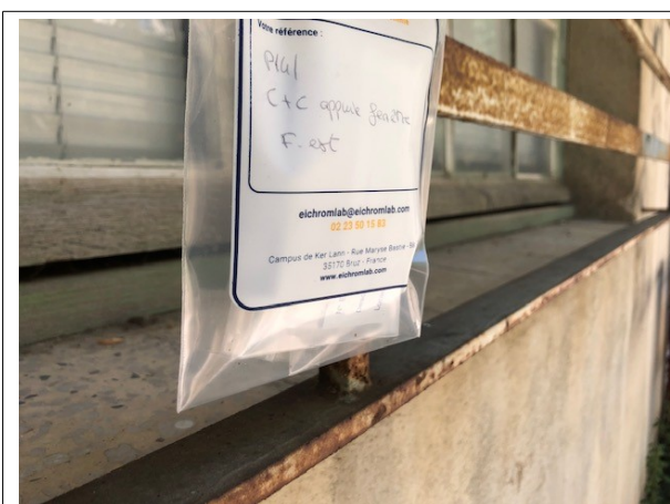
Prélèvement - P141 : BATIMENT ATELIER / Extérieur - Colle de carrelage- (Absence d'amiante)
