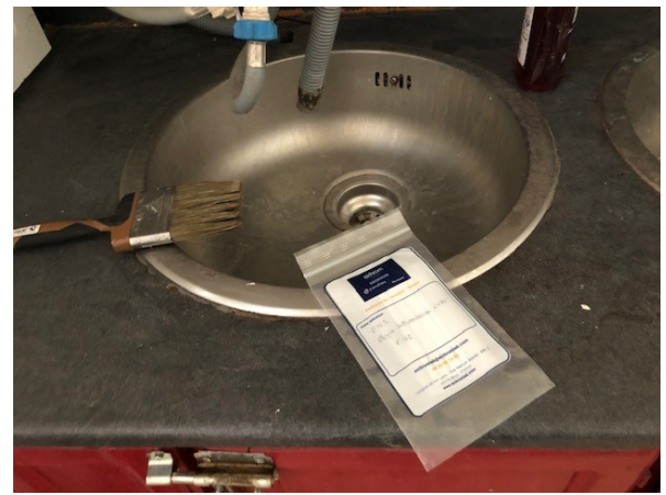
Prélèvement - P165 : BATIMENT ATELIER / Atelier bois 1 / Vestiaire 02 - Plaque bitumineuse- (Absence d'amiante)
