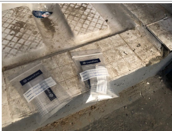
Prélèvement - P047 : BATIMENT ATELIER / Salle de sport / Circulation sanitaires - Colle de carrelage- (Absence d'amiante)
