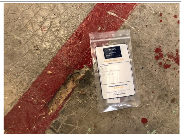
Prélèvement - P151 : BATIMENT ATELIER / Atelier bois 1 - Joint de dilatation- (Absence d'amiante)
