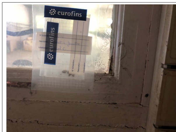
Prélèvement - P012 : BATIMENT ATELIER / Local C - Mastic- (Présence d'amiante)
