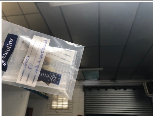
Prélèvement - P057 : BATIMENT ATELIER / Salle de sport - Faux plafond- (Absence d'amiante)
