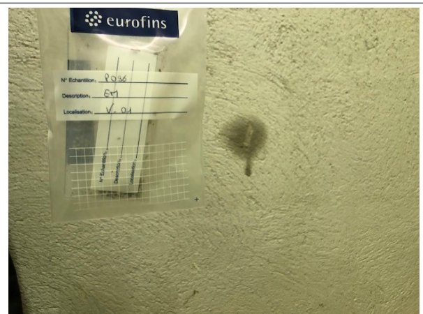
Prélèvement - P096 : BATIMENT ATELIER / Atelier bois 2 / Vestiaire 01 - Enduit- (Absence d'amiante)
