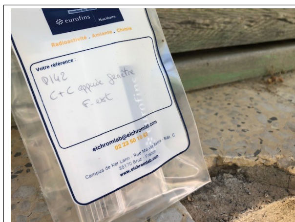
Prélèvement - P142 : BATIMENT ATELIER / Extérieur - Colle de carrelage- (Absence d'amiante)
