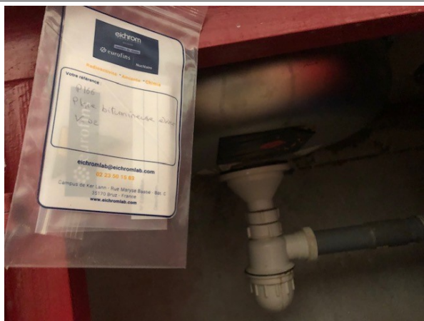
Prélèvement - P166 : BATIMENT ATELIER / Atelier bois 1 / Vestiaire 02 - Plaque bitumineuse- (Absence d'amiante)
