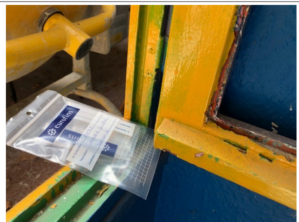
Prélèvement - P076 : BATIMENT ATELIER / Association / Bureau 3 - Mastic- (Absence d'amiante)
