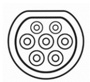
Empreinte d'une prise type T2 ou T2S (version avec obturateurs)
