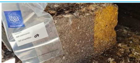
Matériaux : ZPSO-003 Prélèvement : 07 Description : Enduit (petit massif béton) Localisation : Bâtiment ZAP 08 / RdC - Hangar 054 Résultat : Absence d'amiante
