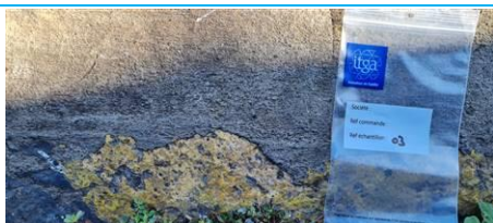
Matériaux : ZPSO-001 Prélèvement : 03 Description : Ragrée (dalle du rail) Localisation : Bâtiment ZAP 08 / RdC - Hangar 054 Résultat : Absence d'amiante
