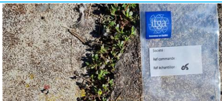
Matériaux : ZPSO-002 Prélèvement : 05 Description : Ragrée (dalle hangar) + joint noir de fractionnement Localisation : Bâtiment ZAP 08 / RdC - Hangar 054 Résultat : Absence d'amiante
