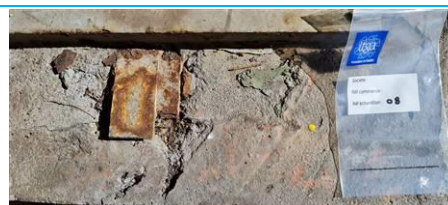
Matériaux : ZPSO-004 Prélèvement : 08 Description : Enduit (gros massif béton) Localisation : Bâtiment ZAP 08 / RdC - Hangar 054 Résultat : Absence d'amiante
