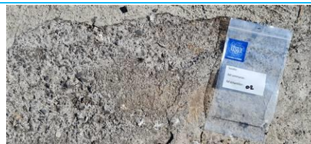
Matériaux : ZPSO-001 Prélèvement : 02 Description : Ragrée (dalle du rail) Localisation : Bâtiment ZAP 08 / RdC - Hangar 054 Résultat : Absence d'amiante
