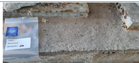
Matériaux : ZPSO-004 Prélèvement : 10 Description : Enduit (gros massif béton) Localisation : Bâtiment ZAP 08 / RdC - Hangar 054 Résultat : Absence d'amiante
