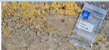
Matériaux : ZPSO-001 Prélèvement : 01 Description : Ragrée (dalle du rail) Localisation : Bâtiment ZAP 08 / RdC - Hangar 054 Résultat : Absence d'amiante
