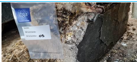
Matériaux : ZPSO-003 Prélèvement : 09 Description : Enduit (petit massif béton) Localisation : Bâtiment ZAP 08 / RdC - Hangar 054 Résultat : Absence d'amiante
