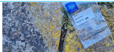
Matériaux : ZPSO-002 Prélèvement : 04 Description : Ragrée (dalle hangar) + joint noir de fractionnement Localisation : Bâtiment ZAP 08 / RdC - Hangar 054 Résultat : Absence d'amiante
