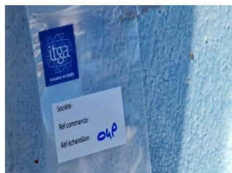
Matériaux : 04P Description : Peinture (grise) Localisation : Poteau métallique extérieur Résultat : Concentration massique en plomb acido-soluble >1.5mg/g
