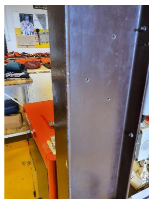
Matériaux : 10P Description : Peinture (marron) Localisation : Local 051 – poteau métallique Résultat : Concentration massique en plomb acido-soluble <1.5mg/g
