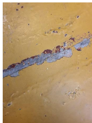
Matériaux : 08P Description : Peinture (jaune) Localisation : Local 051 - Sol Résultat : Concentration massique en plomb acido-soluble <1.5mg/g
