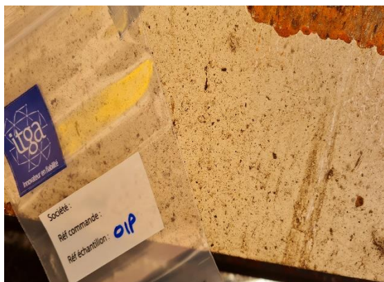
Matériaux : 01P Description : Peinture (blanche) Localisation : Porte monumentale Résultat : Concentration massique en plomb acido-soluble >1.5mg/g
