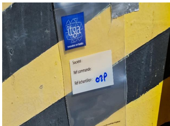
Matériaux : 02P Description : Peinture (noire + jaune) Localisation : Porte monumentale Résultat : Concentration massique en plomb acido-soluble <1.5mg/g
