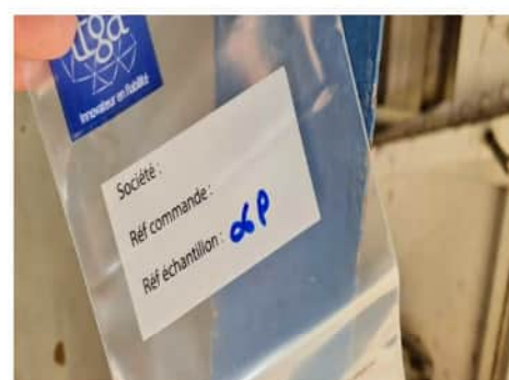
Matériaux : 06P Description : Peinture (grise) Localisation : Poteau métallique intérieur Résultat : Concentration massique en plomb acido-soluble >1.5mg/g
