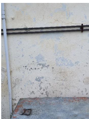
Matériaux : 11P Description : Peinture (blanche) Localisation : Local 051 - façade Résultat : Concentration massique en plomb acido-soluble <1.5mg/g
