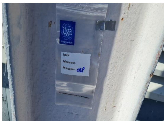
Matériaux : 03P Description : Peinture (bleue) Localisation : Poteau métallique extérieur Résultat : Concentration massique en plomb acido-soluble >1.5mg/g
