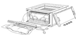
Etape 10 : thermo soudage découpage du sac usagé et blocage du filtre
