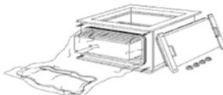
Etape 9 : Mise en place du nouveau filtre dans le caisson
