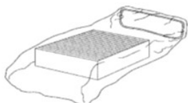
Etape 6 : Insertion du filtre neuf dans le nouveau sac
