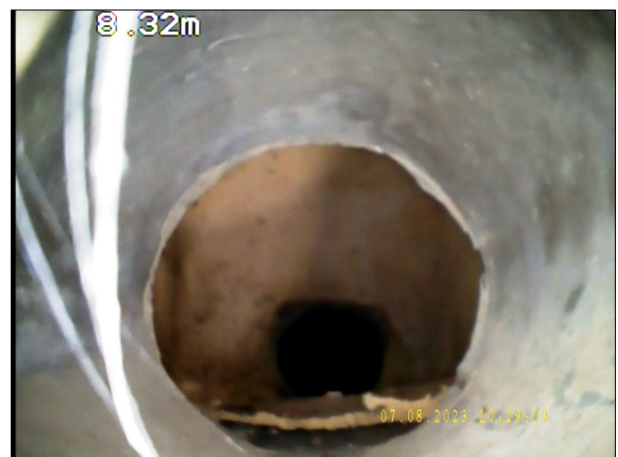
Photo: 4_3A, N° de bande vidéo: 0980 8.7m, Autre objet gisant sur le radier à 6 h. réduction de la section transversale: 10 %
