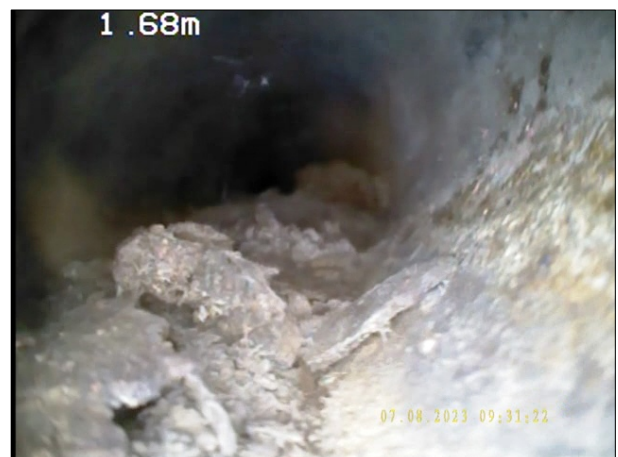
Photo: 7_3A, N° de bande vidéo: 0966 1.9m, Dépôts de matériau grossier (gravats, gravier) sur le radier de 3 à 9 h. épaisseur des dépôts: 40 %
