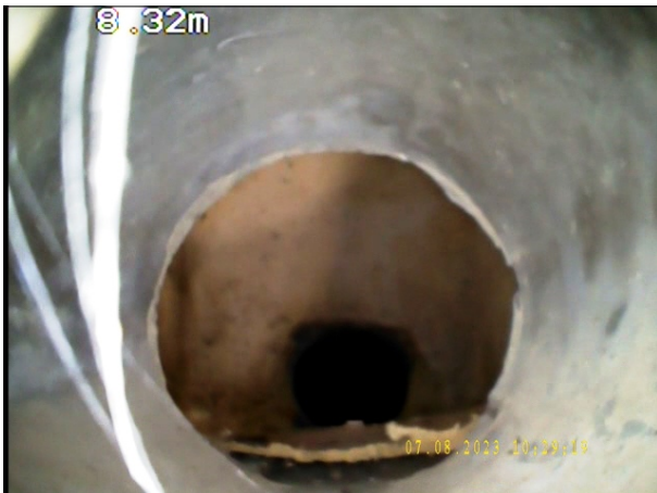
Photo: 4_4A, N° de bande vidéo: 0980 8.9m, Noeud d'arrivée, Boîte d'inspection, REP3
