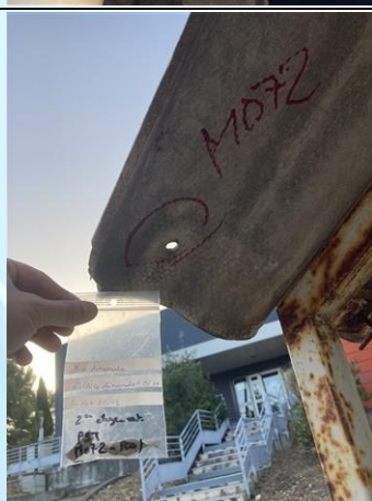
Photo n° PhA072 Localisation : MLU - MLU020 - EXTERIEUR - EXTERIEUR Ouvrage : 1 - Couvertures, Toitures, Terrasses et étanchéités - Plaques ondulées et planes Partie d'ouvrage : Plaques en fibres-ciment (y compris plaques « sous tuiles ») Description : PLAQUES SOUS TUILE
