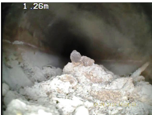
Photo: 28_2A, N° de bande vidéo: 0965 1.3m, Dépôts de matériau sur le radier, autre : Matériau atelier de 5 à 7 h. épaisseur des dépôts: 10 %
