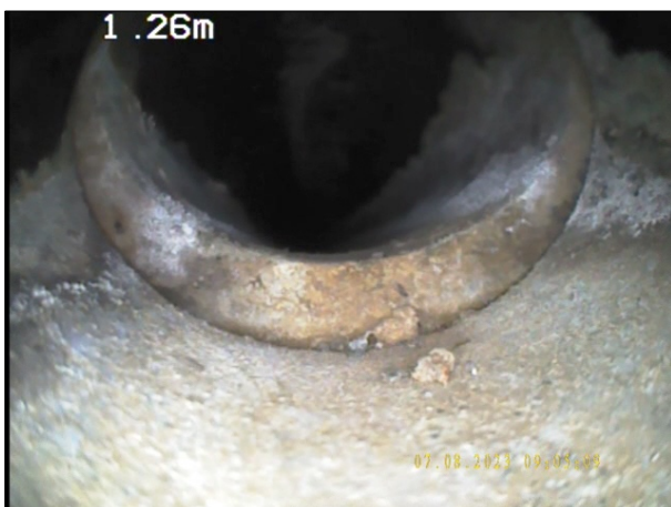
Photo: 20_2A, N° de bande vidéo: 0957 1.3m, Déplacement d'assemblage, radial de 10 à 2 h. déplacement: 15 mm
