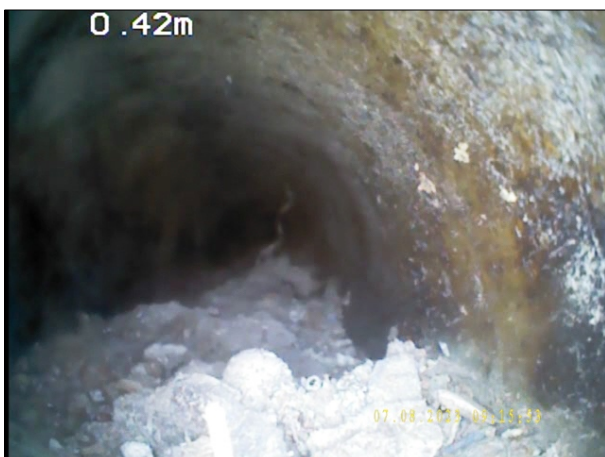
Photo: 22_2B, N° de bande vidéo: 0961 0.25m, Dépôts de matériau sur le radier, autre : Matériau atelier de 3 à 9 h. épaisseur des dépôts: 50 %
