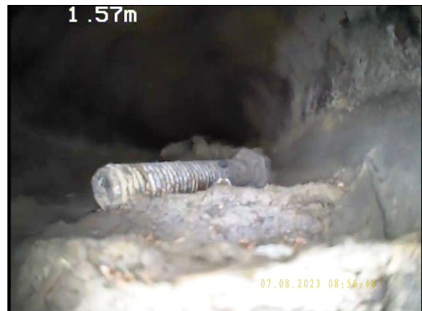
Photo: 14_4A, N° de bande vidéo: 0956 1.65m, Autre objet gisant sur le radier de 5 à 7 h. réduction de la section transversale: 10 %
