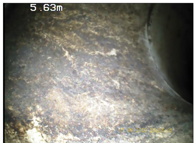
Photo: 10_5A, N° de bande vidéo: 0980 5.6m, Inspection abandonnée, obstruction. Inspection terminée avant d'avoir atteint le noeud d'arrivée
