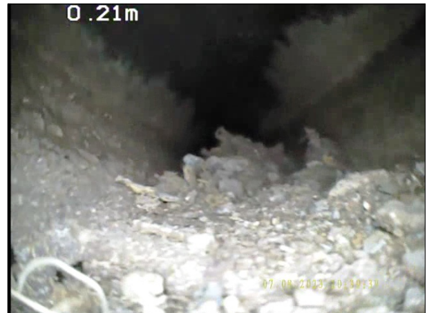
Photo: 29_2A, N° de bande vidéo: 0982 0.4m, Dépôts adhérents, encrassement de 5 à 7 h. réduction de la section transversale: 15 %
