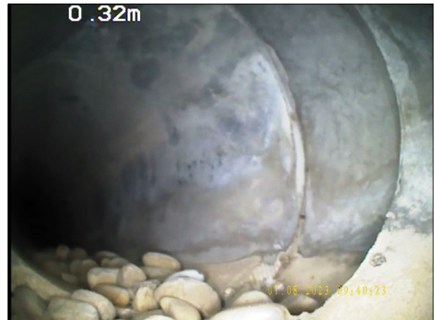
Photo: 1_2A, N° de bande vidéo: 0970 0.32m, Dépôts de matériau grossier (gravats, gravier) sur le radier à 6 h. épaisseur des dépôts: 5 %
