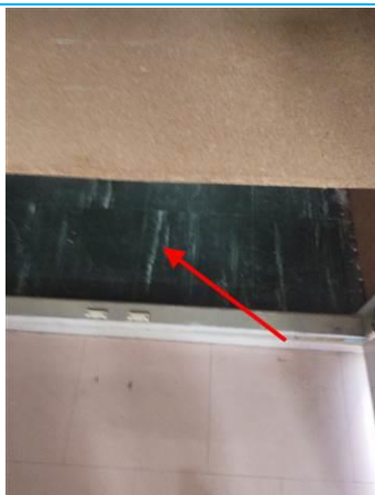
Matériaux : ZPSO-001 Prélèvement : P001 Description : Dalle de sol Localisation : BATIMENT ADMINISTRATIF / RDC - SALLE REPROGRAPHIE Résultat : Présence d'amiante
