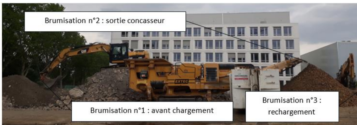
Figure 27. Principe de brumisation du concassage
