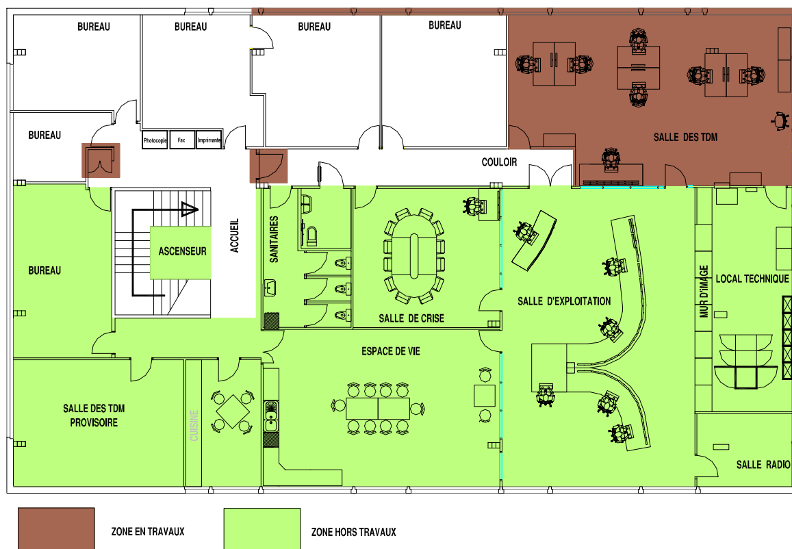
Fig. 20. Plan de masse des travaux en phase 5
