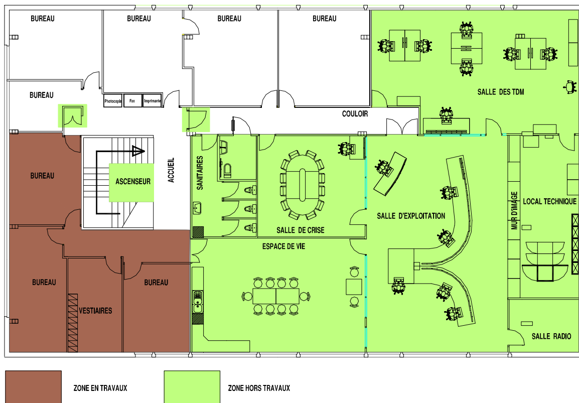
Fig. 21. Plan de masse des travaux en phase 6
