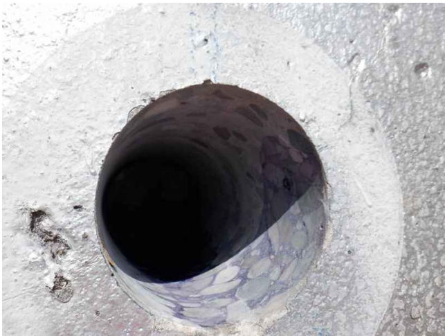
- Photographie du carottage au droit d'un signal ferroskan -
