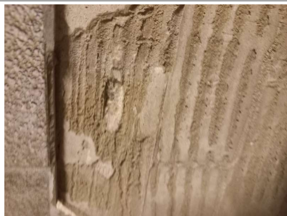
Prélèvement - P02 : R+3 / Cage d'escalier - Colle de carrelage- (Présence d'amiante)
