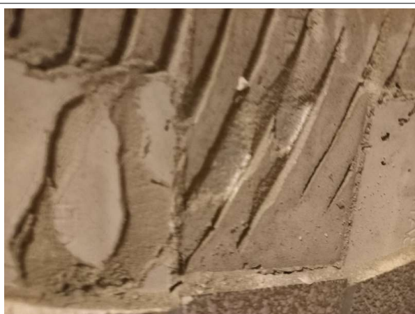
Prélèvement - P03 : R+1 / Cage d'escalier - Colle de carrelage- (Présence d'amiante)
