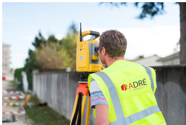
Image 4 : Station Totale robotisée
