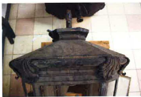
Feuillages et éléments en tôle pliée : zone de rouille, Peinture dégradée, cuivre apparent
