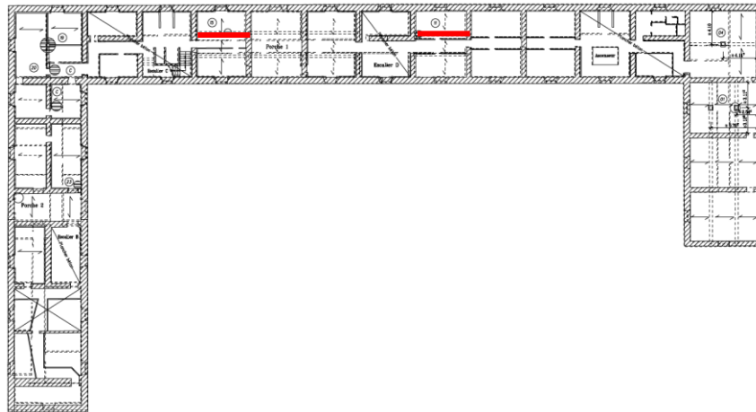
Figure 27 : Localisation des poutres des sondages 5 et 6
