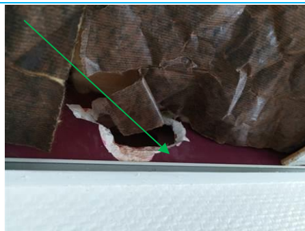
Matériaux : ZPSO-002 Prélèvement : P002 Description : Plâtre+Enduit-Mur Localisation : RDC - Salle Patio Résultat : Absence d'amiante
