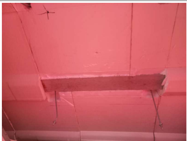
Prélèvement - P011 : Bâtiment le Saint Henri / Rez-de-chaussée droit / Local 1 - Enduit- (Absence d'amiante)
