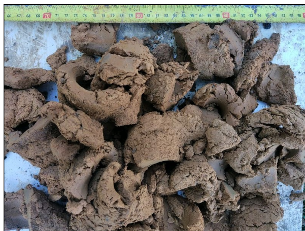
Sol : limon +/- argileux brun En T3 entre -1,1 et -3,0 m/TN
